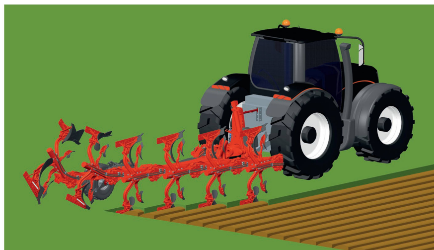
La commande individualisée des corps de charrue «Section Control» produit des bordures très propres et nettes. Photo : Kuhn
