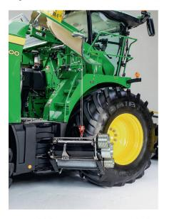
Le nouvel éclateur «XStream KP» est doté de rouleaux de plus grand diamètre, de 250 mm.
