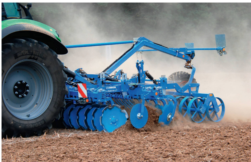
Le « Rubin 10 » est ici équipé d'une roue « Unirad ». Ce système mécanique de roue décharge l'essieu arrière du tracteur et réduit le besoin de puissance de levage. Photos : Heinz Röthlisberger
