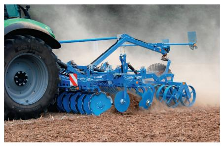
Le «Rubin 10» est ici équipé d'une roue «Unirad». Ce système mécanique de roue décharge l'essieu arrière du tracteur et réduit le besoin de puissance de levage. Photos: Heinz Röthlisberger
