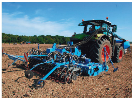
Maniable et compact: le semoir solo « Optidisc 25 » est combiné avec la herse rotative « Zirkon 12 » et le réservoir à semences frontal « Solitaire 23 ».
