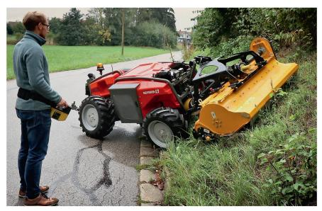
Le «Metron P48 RC», le porte-outils radiocommandé de Reform, est entraîné par quatre moteurs-roues électriques. Photo: Idd
