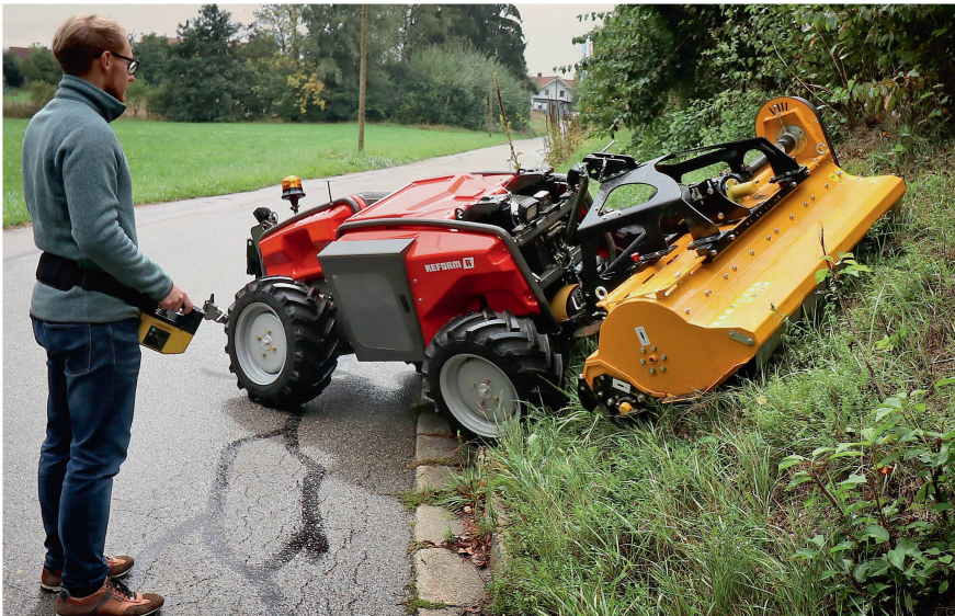
Le « Metron P48 RC », le porte-outils radiocommandé de Reform, est entraîné par quatre moteurs-roues électriques. Photo: ldd
