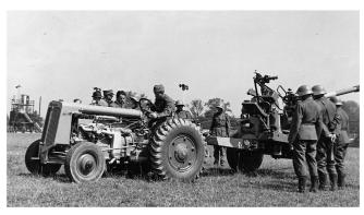
Cet Hürlimann «4 T 42» de 1932 est équipé d'un moteur à pétrole Hürlimann «4 B 100» de 40 chevaux et dispose d'une transmission à 5 rapports, d'un blocage de différentiel et de freins à mâchoires intérieures sur les roues arrières.
