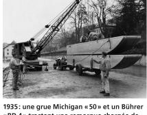
«BD 4» tractant une remorque chargée de deux pontons modèles «1930/31». Le ponton pèse 550 kg pour une capacité de charge de 4500 kg pour 30 cm de franc-bord.
