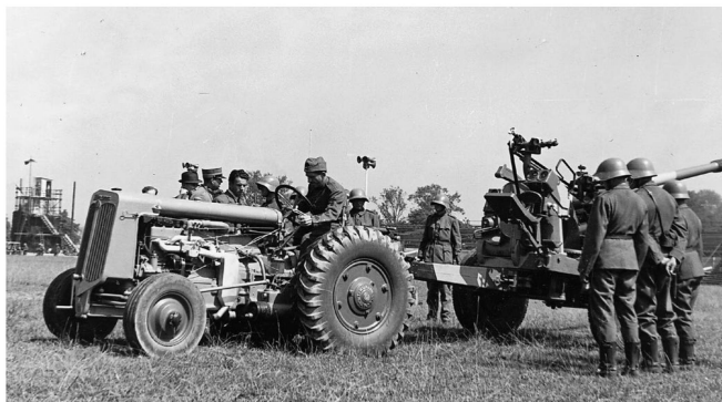
Cet Hürlimann « 4 T 42 » de 1932 est équipé d'un moteur à pétrole Hürlimann « 4 B 100 » de 40 chevaux et dispose d'une transmission à 5 rapports, d'un blocage de différentiel et de freins à mâchoires intérieures sur les roues arrière.
