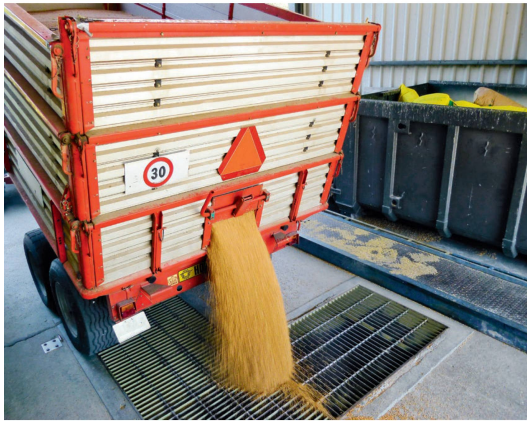
La plaque d'identification arrière signale un véhicule lent. Photo: Ruedi Hunger
