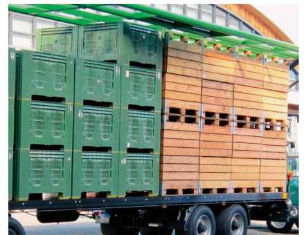
La sécurisation latérale des grosses caisses et des paloxes représente un défi. Photo: Oehler
