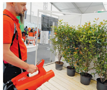
Le souffleur portable à accus du pulvérisateur à dos Birchmeier assure une vaporisation optimale à une distance de 0,5 à 15 m.
