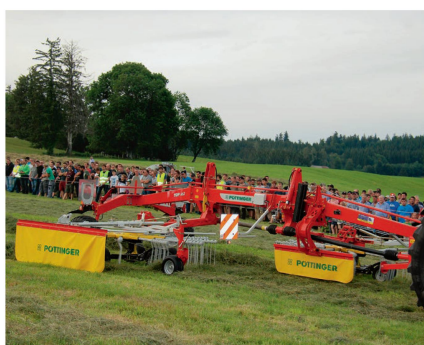
Andaineur à deux toupies Pöttinger «Top 662» de: l. de travail de 6,55 à 7,3m, poids de 1990 kg et puissance nécessaire de 60 ch.
