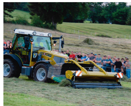
Andaineur frontal à tapis Knüsel «Air Swath 300-70»: largeur de travail de 3m, poids de 810 kg et puissance nécessaire de 80 ch.
