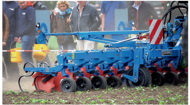
Sur la machine de Carré, les roues de jauge équipant chaque élément de binage pour le suivi du terrain se règlent par une vis de réglage.
