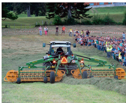
Andaineur à peignes «Twin 750» d'Elho: largeur de travail de 3 à 7,5m, poids de 2100 kg et puissance nécessaire de 70 ch.
