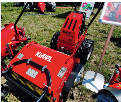
Le monoaxe compact à moteur électrique, batterie 48 volts et contrôle de puissance optimisé Köppl offre 3 heures d'autonomie.
