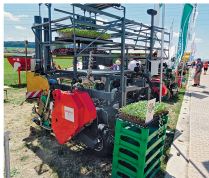
« Plant Tape » de Jampen Landmaschinen et Swissplant assure les opérations de semis d'une bande jusqu'à sa pose en plein air.
