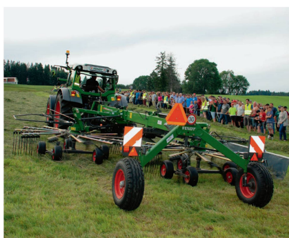
Andaineur à deux toupies «Former 1452» de Fendt, largeur de travail de 5,8 à 6,7m, poids 4270 kg et puissance nécessaire de 50 ch.
