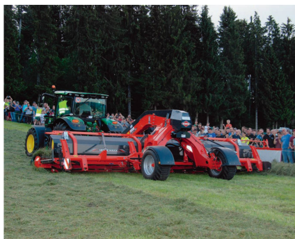
Andaineur à tapis «Mergé Maxx 950» de Kuhn: largeur de travail de 9,50m, poids de 4840 kg et puissance nécessaire de 85 ch.
