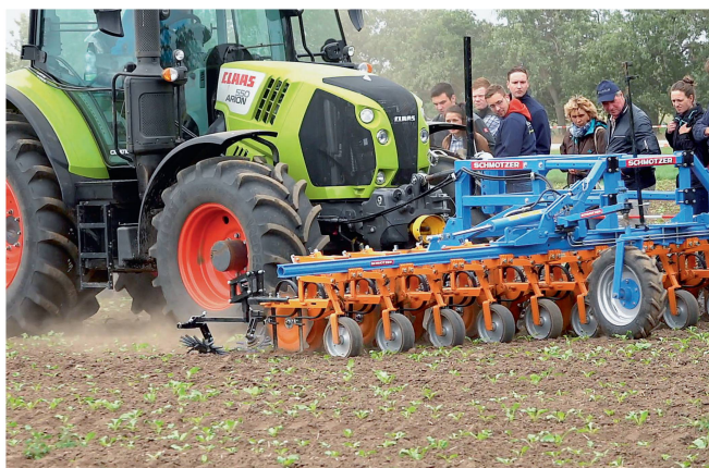
Ergonomique et avantageuse, la bineuse frontale de Schmotzer est dotée en option d'un guidage par caméra. Photos : Ruedi Burkhalter
