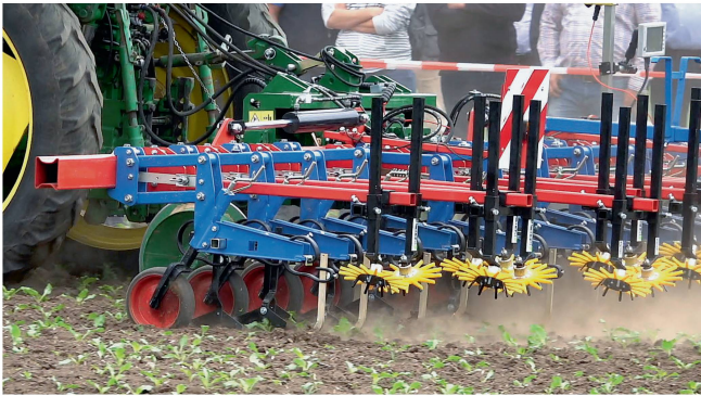
Le système de binage « Habicht » de la société Kress comporte des dispositifs de guidage par caméra et de translation de Garford.
