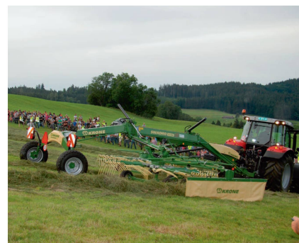
Andaineur à deux toupies Krone «Swadro TS 680 Twin»: l. de travail de 6,8 à 7,6m, poids de 4270 kg et puissance néc. de 50 ch.
