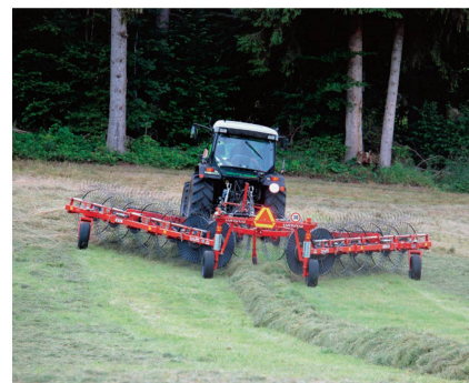
Andaineur soleil «Raptor V14 Pro AW» de Tonutti: largeur de travail de 7,6m, poids de 1300 kg et puissance nécessaire de 30 ch.
