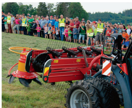
Râteau-faneur frontal «Super 230» de Molon: largeur de travail de 2,3m, poids de 255 kg et puissance nécessaire de 25 ch.
