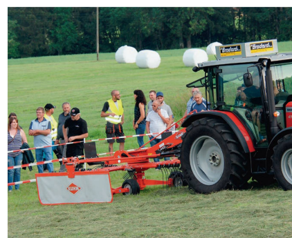
Andaineur à une toupie «GA 4431» de Kuhn: largeur de travail 4,4m, poids de 724 kg et puissance nécessaire de 30 ch.
