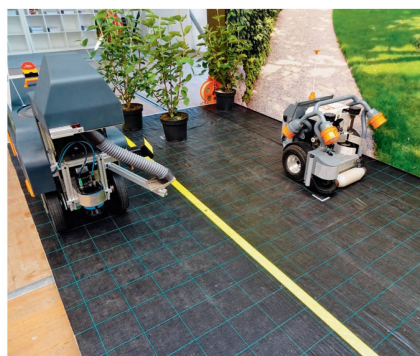
Le robot Hauert ne déplace pas des montagnes, mais des pots. Il peut en outre communiquer avec un épandeur d'engrais.
