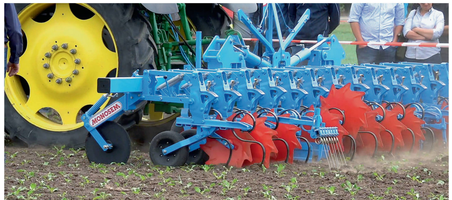
Grâce à l'important dégagement entre le châssis et le sol (jusqu'à 70 cm), la bineuse « Multicrop » de Monosem autorise des interventions tardives.
