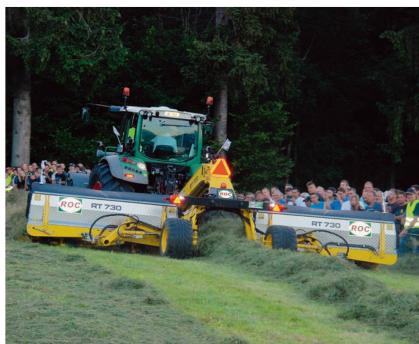
Andaineur à pick-up et tapis «RT 730» de ROC: largeur de travail de 7,30m, poids de 3196 kg et puissance nécessaire de 100 ch.
