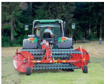
Andaineur à peignes «74/51XL» de Repossi: largeur de travail de 4m, poids de 580 kg et puissance nécessaire de 40 ch.
