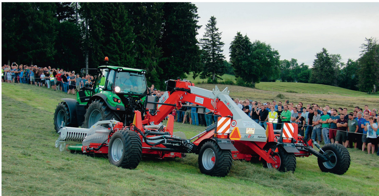
Andaineur à pick-up et tapis «Respiro R9» de Reiter: largeur de travail de 9 m, poids de 6400 kg et puissance nécessaire de 120 ch.
