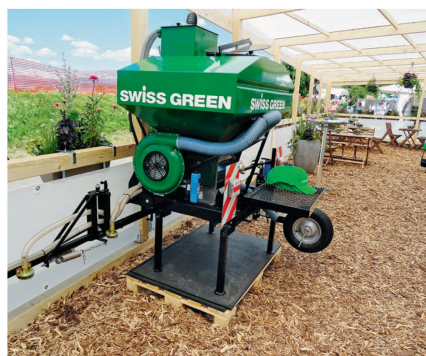
Le distributeur d'engrais hydropneumatique Swiss Green sert à l'application exacte des nutriments et au sursemis de gazon.
