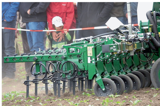
La particularité de la bineuse de Garford est sa gestion automatique des tronçons.
