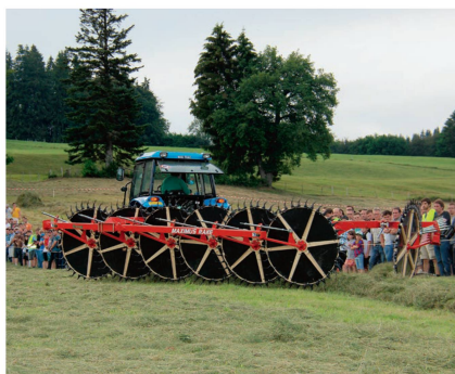
Andaineur soleil «Easy Rake 12» d'Enorossi: largeur de travail de 7,4m, poids de 1430 kg et puissance nécessaire de 45 ch.
