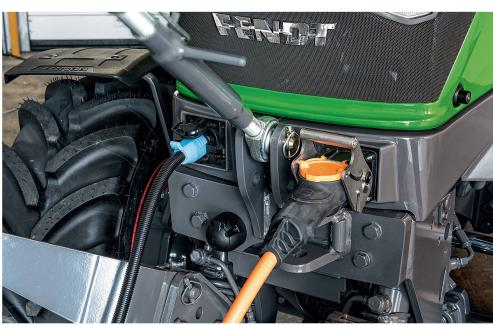
Le Fendt «e100 Vario» muni d'une batterie 650 V lithium-ion à hautes performances est encore une exception et non la règle. Photo: Fendt
