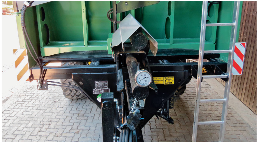
Les deux vérins de poussée sont montés à l'avant afin d'utiliser le volume de chargement au maximum. Le manomètre indique en continu le niveau de précompression de la paroi coulissante.
