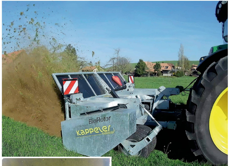
Le processus de fonctionnement du « BioRotor » lui permet d'arracher les plantes avec leurs racines et de les séparer presque complètement de la terre.
