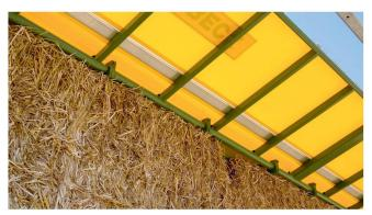
La stabilité de la structure en forme de toit est transmise aux ridelles par de solides paliers sans entretien.
