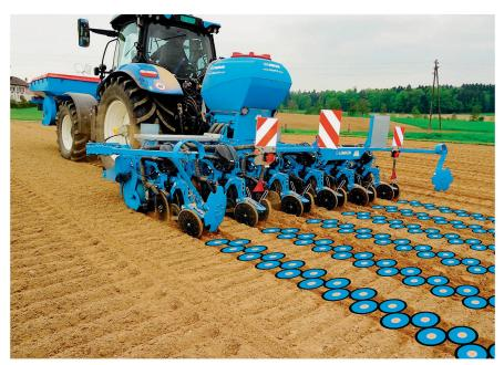
Cette variante rabattable à 6 rangs de 4,5 m de large de l'« Azurit 9 » comporte un module pour l'enfouissement de la fumure. Les lignes de semis sont distantes de 12,5 cm. Dans le sens de la longueur, une graine est déposée tous les 14,8 cm, une fois à gauche, l'autre à droite. Photos: Roman Engeler
