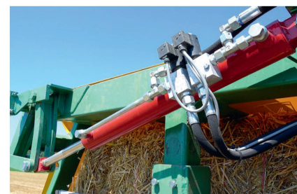
Chaque vérin est branché sur un circuit en boucle et dispose de sa propre vanne à commande électromagnétique.
