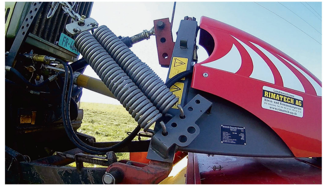
Les ressorts de décharge (en position de travail) doivent être positionnés dans un angle de 45° par rapport au sol.
