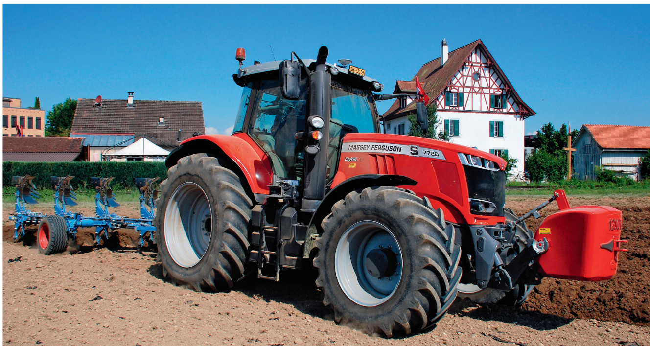
Le MF « 7720 S Dyna-VT » tirant une charrue 5 socs. Son 6-cylindres développe jusqu'à 220 chevaux avec le dispositif de surpuissance (boost).
