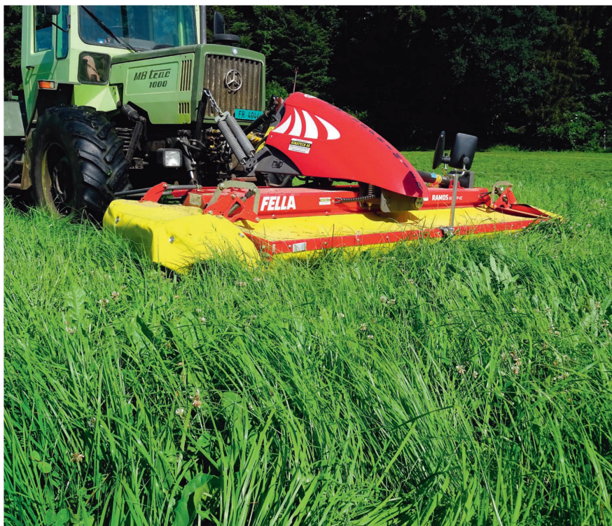
La faucheuse frontale à disques «Ramos 3060» de Fella équipée d'un conditionneur à dents est un engin vraiment léger. Photos: Roman Engeler
