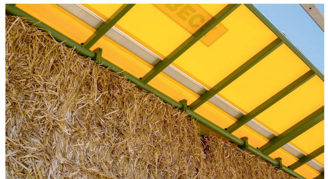
La stabilité de la structure en forme de toit est transmise aux ridelles par de solides paliers sans entretien.
