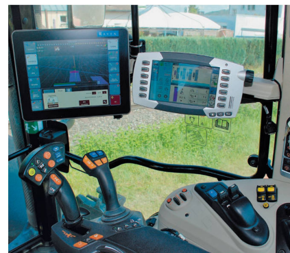
Le poste de conduite du MF de Rathgeb avec levier de commandes, joystick, terminal « Datatronic » et GPS SBG (en haut à g.).
