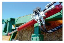
Chaque vérin est branché sur un circuit en boucle et dispose de sa propre vanne à commande électromagnétique.
