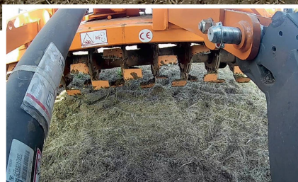
La fraise Falc est proposée en trois largeurs, de 3 à 6 m; elle a été optimisée pour les façons superficielles de l'horizon du sol où se concentrent les racines.
