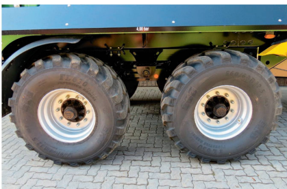
L'essieu tandem avec essieu suiveur s'avère parfaitement adapté et se comporte très bien sur route.
