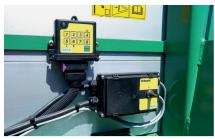
Le système se pilote à distance. Si la télécommande fait défaut, on peut recourir au clavier sur la remorque.
