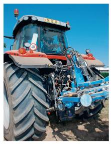
Le tracteur lève 9600 kg à l'arrière, où il dispose aussi de 5 distributeurs hydrauliques, d'une prise ABS, d'un double raccord de frein pneumatique et d'un raccord de frein hydraulique à simple circuit.
