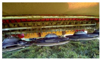
Six disques en paires tournant à contresens amènent le fourrage en trois mini andains vers le conditionneur.
