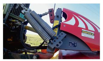
Les ressorts de décharge (en position de travail) doivent être positionnés dans un angle de 45° par rapport au sol.
