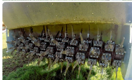
Le processus de fonctionnement du « BioRotor » lui permet d'arracher les plantes avec leurs racines et de les séparer presque complètement de la terre.
