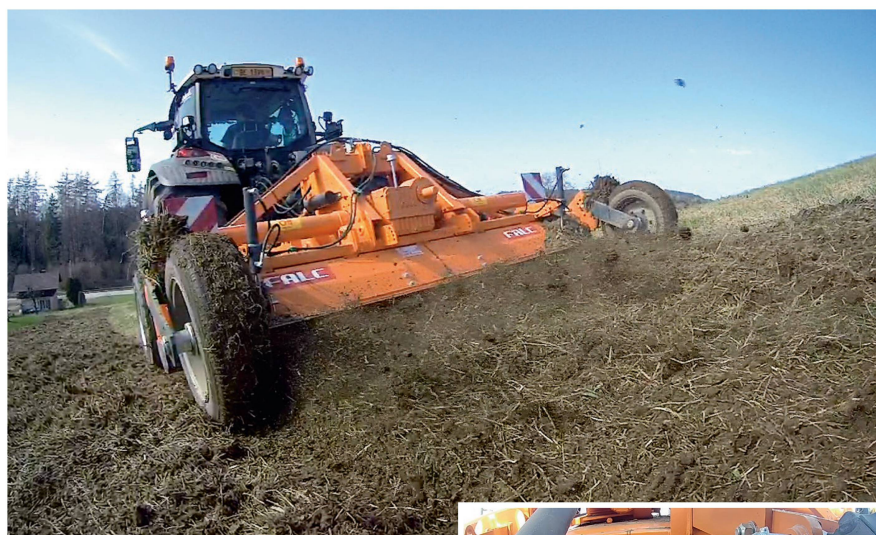
La fraise Falc est proposée en trois largeurs, de 3 à 6 m; elle a été optimisée pour les façons superficielles de l'horizon du sol où se concentrent les racines.
