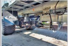
Photo de gauche: l'alimentation électrique de l'entraînement de la remorque à fond mouvant Fliegl avec essieu moteur FSA (Fliegl Self-propelled-axle) est assurée par une prise située sur le tracteur.
