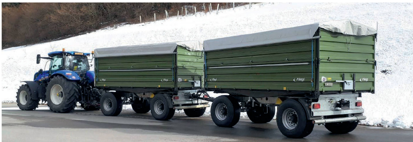
L'attelage testé consistait en un tracteur New Holland «T7.270» équipé en usine d'un frein hydraulique à double circuit et attelé à deux remorques Fliegl «DK180» (chacune avec un poids total autorisé de 18t) à essieu avant sur lesquelles a été monté un système de freinage «H2L» de Paul Forrer. Photo: Paul Forrer AG
