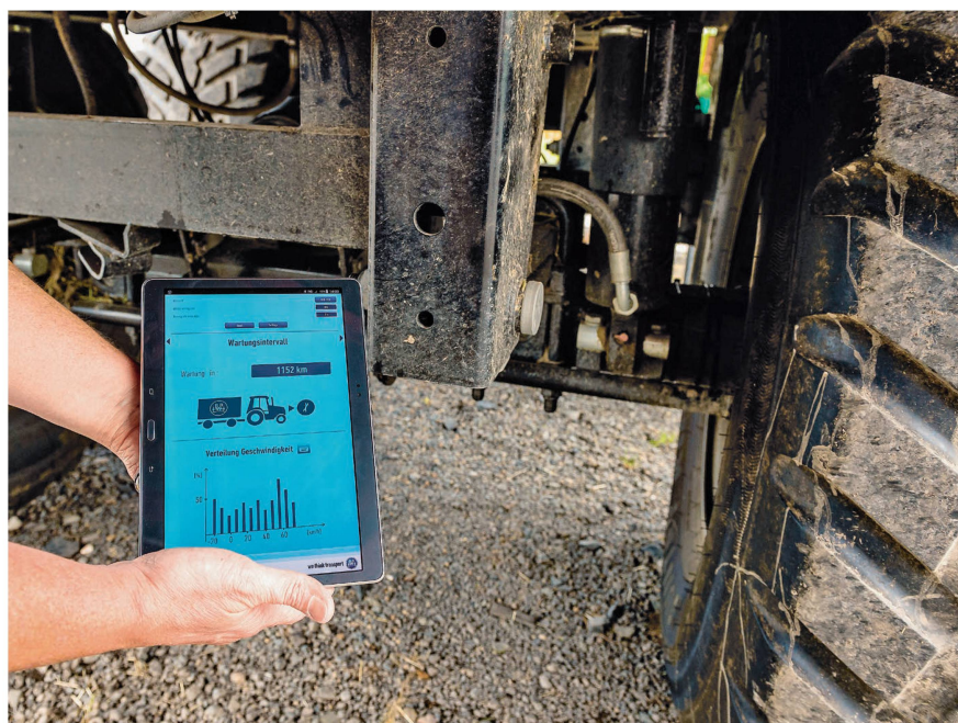
Des passages de roue à la tablette ou au smartphone, « Agro Hub » transmet les données mesurées sans fil.
