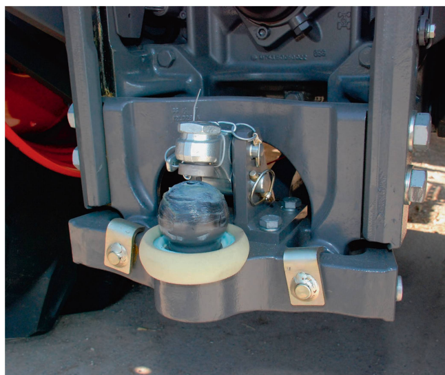
L'attelage à boule 80 a gagné en popularité ces dernières années. Ses avantages sont sa position basse et la grande surface de contact, sans jeu, entre la remorque et le tracteur.
