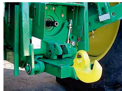
Le crochet « Hitch » n'a pas réussi à s'imposer chez nous, notamment à cause de la surface de contact réduite avec l'œillet, qui peut entraîner une usure considérable.
