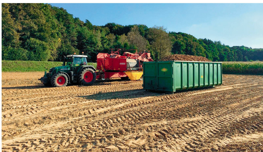
Les remorques porte-caissons, aussi appelées « multibennes », sont surtout utilisées pour des travaux où les conteneurs sont remplis sur place. Photos : Romain Fonk
