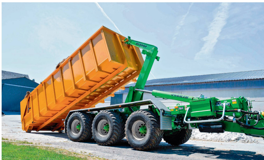
L'angle de soulèvement d'une remorque porte-caissons est à respecter, sinon, les produits en vrac comme le colza risquent de déborder par-dessus la paroi du conteneur.
