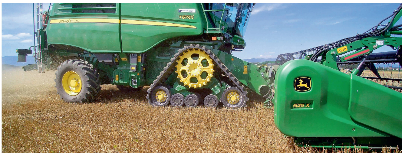
Les cinq galets des nouvelles chenilles ont pour objectif d'améliorer grandement le confort de conduite de la moissonneuse-batteuse.
