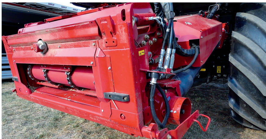
Le convoyeur été renforcé et équipé d'un dispositif d'inclinaison optionnel.
