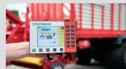
être installé partout et dans n'importe quelle position. L'« Expert 75 » possède un écran couleur de 5,6 pouces et des touches rétroéclairées, qui facilitent l'utilisation nocturne. Des haut-parleurs et un port USB 2.0 sont intégrés et rendent le système plus polyvalent.
