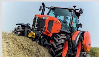
les trois modèles du haut de la gamme. Ces tracteurs disposent aussi d'un alternateur de 150 A pour répondre aux besoins des équipements intégrés. Le relevage arrière (cat. III) offre une capacité de relevage de 5000 kg et la pompe hydraulique débite 133 l/min sur les deux modèles d'entrée de gamme, respectivement 6100 kg de capacité de relevage et 143 l/min de débit pour les trois grands véhicules. Un tout nouveau relevage avant est disponible en option.
