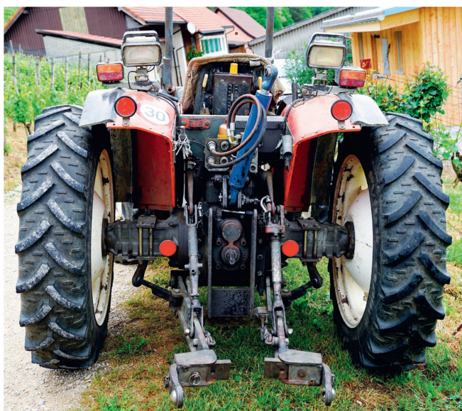
En retournant les roues du Carraro, sa voie passe de 1,1 à 1,5 mètre.
