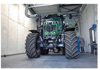
On a également intégré un nouveau banc d'essais où les performances de tracteurs jusqu'à 300 ch pourront être analysées.
