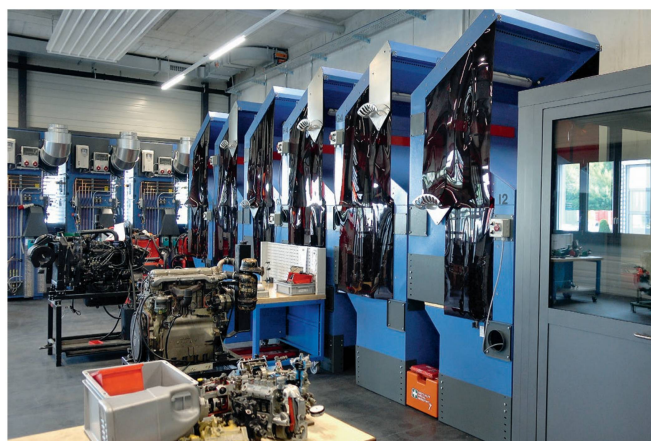
Les seize postes de soudage ultra-modernes sont mobiles, ce qui permettra d'utiliser aussi les locaux à d'autres fins.
