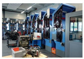
Les seize postes de soudage ultra-modernes sont mobiles, ce qui permettra d'utiliser aussi les locaux à d'autres fins.
