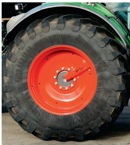
Fendt propose le « Vario-Grip », un dispositif de réglage de pression embarqué incorporé en usine dans ses gros tracteurs. Un système d'assistance attire l'attention du conducteur lorsque la pression de gonflage est trop basse ou trop élevée. Photo : Tammo Gläser
