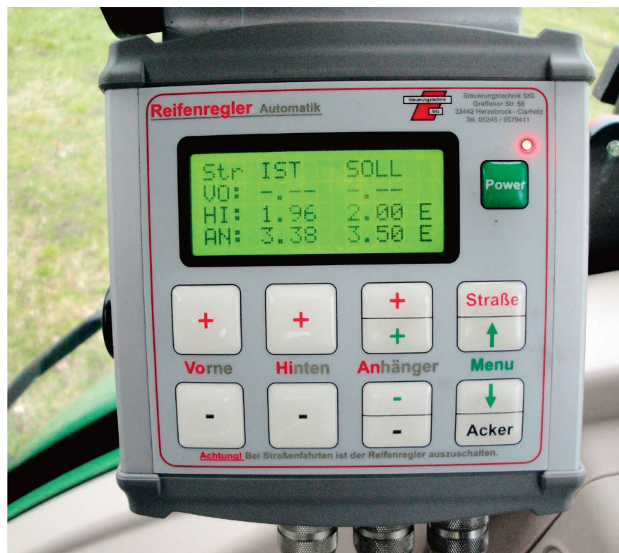
Exemple d'un contrôleur numérique universel capable de gérer la pression de gonflage des pneus du tracteur et de la remorque. Photo : Ludwig Volk
