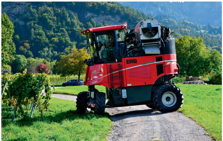
Grâce à son angle de braquage de 90°, la machine à vendanger offre une maniabilité impressionnante.
