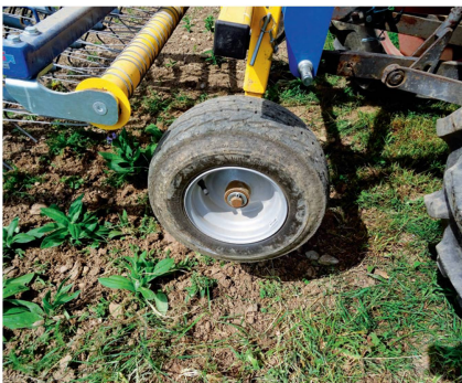
Le réglage de la profondeur se fait via des roues de jauge disposant de six positions le long d'un rail perforé.
