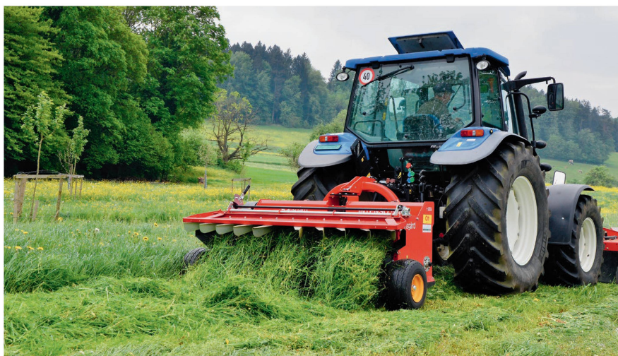
Dans les pentes, la combinaison de la faucheuse frontale et du conditionneur arrière assure une répartition de poids idéale. Photos : Ruedi Hunger
