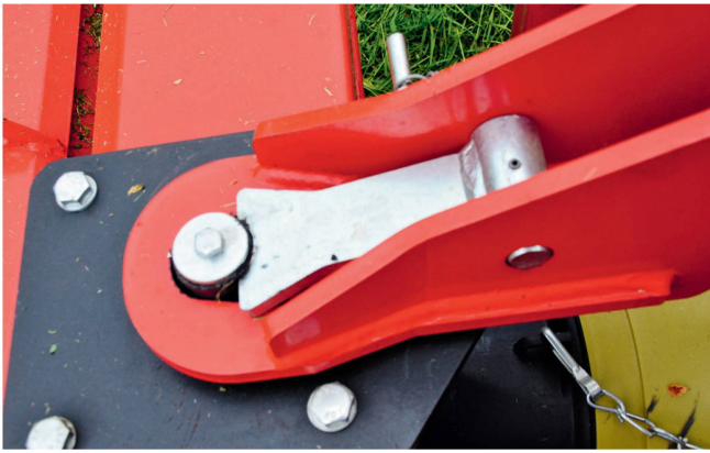
Un détail important en pente: le verrouillage de l'attelage pivotant assure un suivi directionnel stable.
