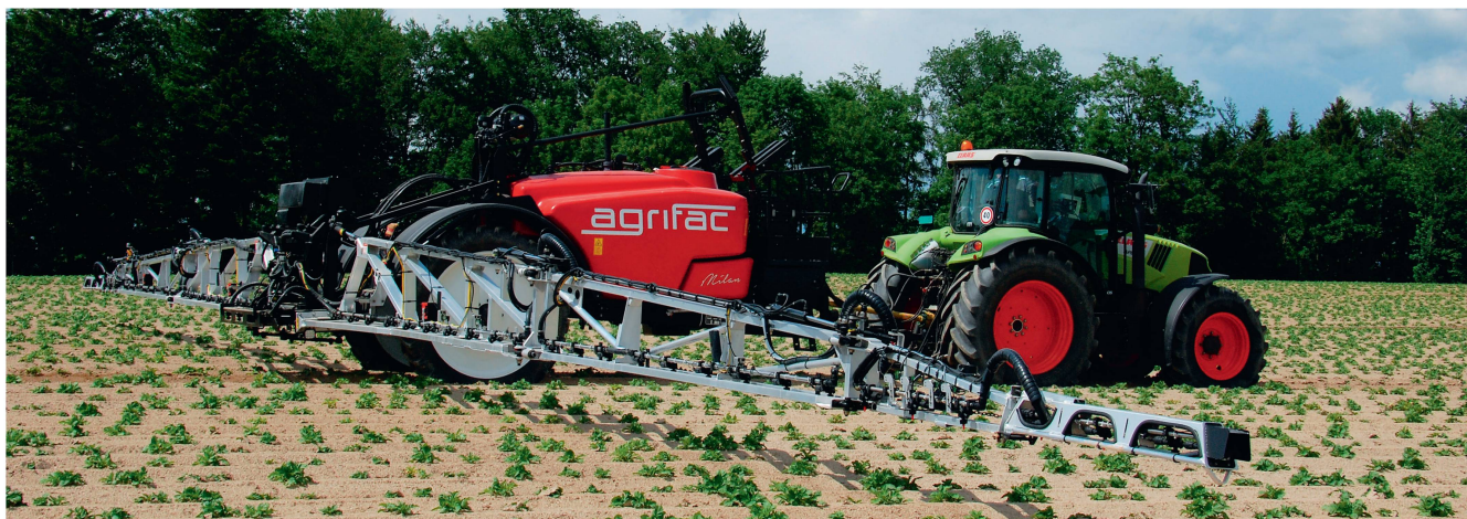
Le « Milan » est muni d'une cuve de 3500 litres, d'une rampe de 27 mètres et d'un circuit de pulvérisation « GreenFlowPlus » qui assure une pression constante et régulière. Photos : Heinz Röthlisberger
