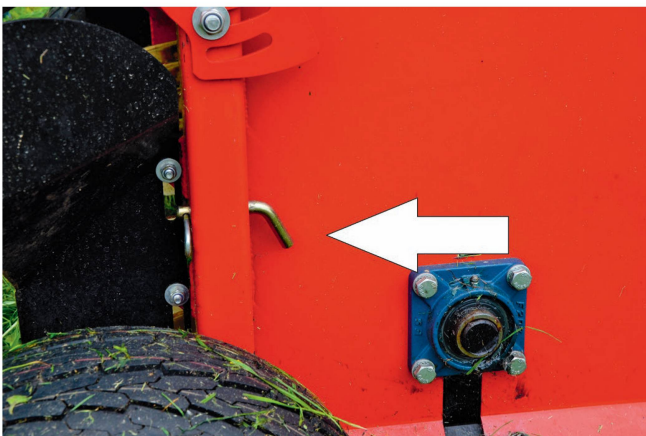
La profondeur est réglée via le châssis (et le bras supérieur).
