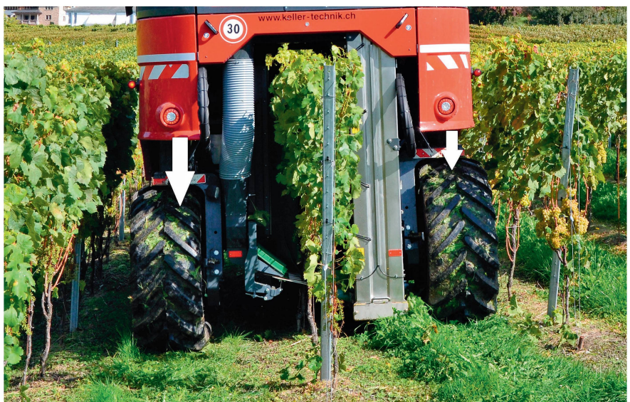
Un dispositif de compensation latérale automatique guide la machine horizontalement dans la rangée de ceps.
