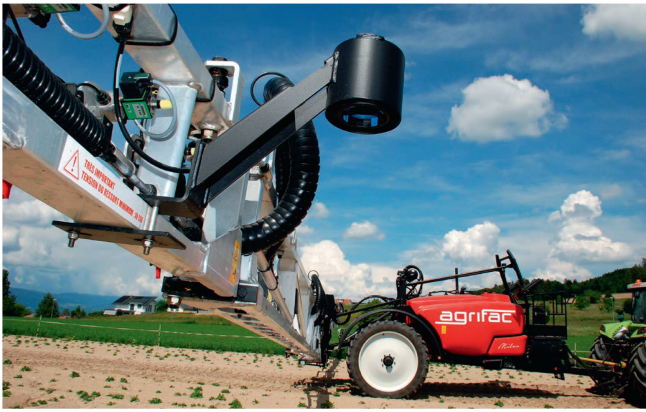
Les capteurs de distance à ultrasons maintiennent un espace optimal entre la rampe et la surface à traiter.
