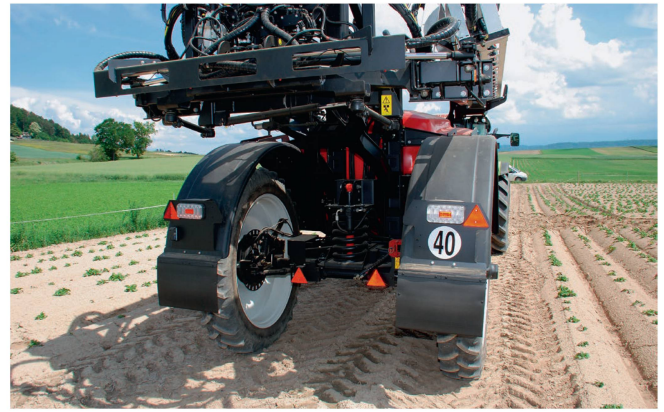
Le ressort hélicoïdal central généreux assure un bon confort de conduite. La direction de l'essieu peut être verrouillée sur route.
