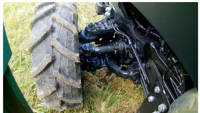
En option, on peut obtenir un essieu avant à ressort avec suspension indépendante des roues à commande électronique.
