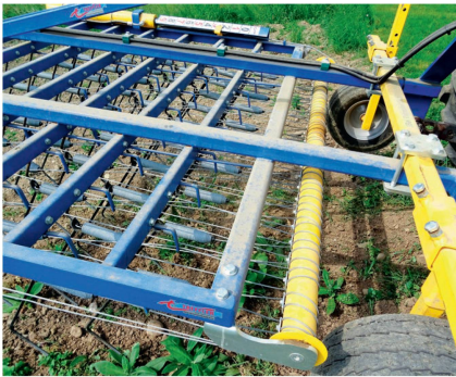
La pression des dents se règle hydrauliquement par des câbles reliés à un arbre rotatif à l'avant, ceci de manière centrale et par échelonnement.
