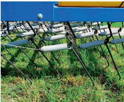
La pression de chaque dent est produite par la tension de ressorts de traction.
