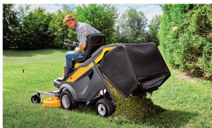
Les modèles les mieux équipés permettent de vider le bac depuis le siège. De telles fonctions sont souvent optionnelles.
