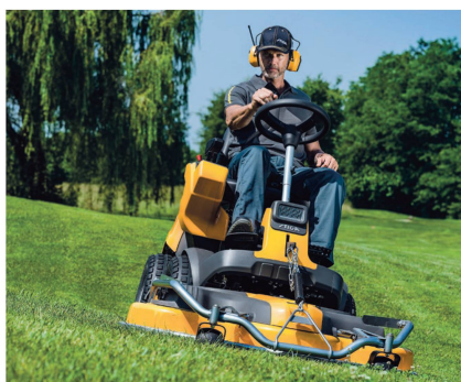
Les tondeuses autoportées offrent une vue optimale sur le dispositif de coupe. Certains modèles ont un châssis articulé.
