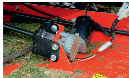
Les moteurs électriques servant à lever le dispositif de coupe sont pratiques, mais gare aux pannes désagréables pendant la tonte!
