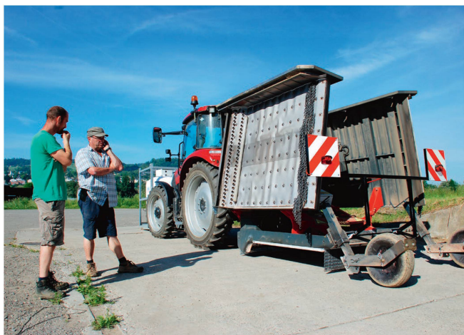
«Ce désherbeur thermique Hoaf neuf de 4,5 mètres est plus puissant et consomme moins de gaz que l'ancien», explique Martin Müller.
