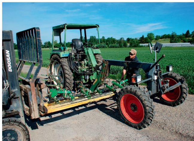
La surélévation des poutrelles des porte-outils Fendt permet de monter diverses étrilles et bineuses sans gêne.
