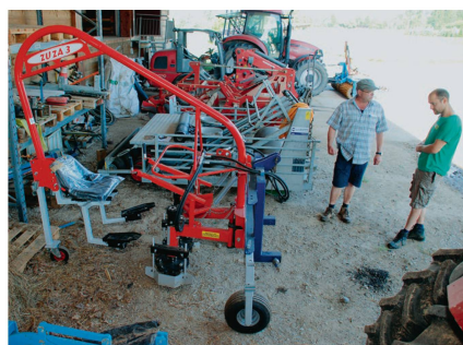
Acquise récemment, la « Zuza 3 » du fabricant polonais Jagoda peut être utilisée dans les cultures monorang comme la rhubarbe.
