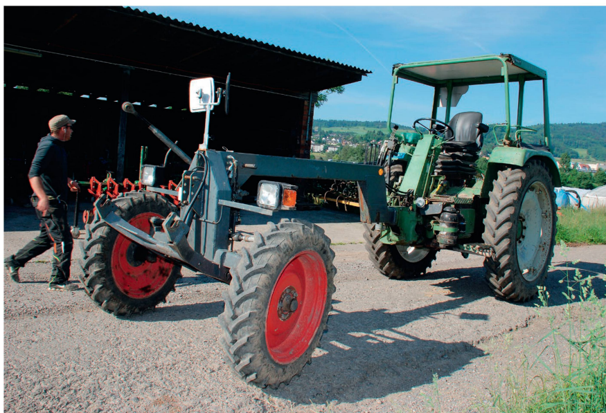
Le Fendt «GT 250» à poutrelle surélevée est l'un des trois porte-outils utilisés sur les exploitations biologiques de Stephan Müller et de Martin Müller. Photos: Heinz Röthlisberger
