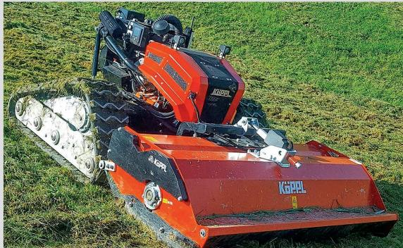
progresser en ligne droite dans tous les talus. Des capteurs mesurent le régime de rotation des roues et assurent le guidage de la machine. L'allure est réglable en continu jusqu'à son maximum de 6 km/h grâce au régulateur de vitesse commandé par radio. Après un passage d'obstacle ou un demi-tour, le véhicule reprend automatiquement la vitesse programmée.
