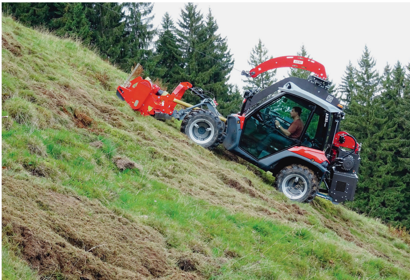
Mariage de tradition et d'innovation tout en compacité sur une machine du dernier cri: le treuil de traction auxiliaire du porte-outils à deux essieux Aebi «TT 281» permet de travailler sur des pentes très escarpées. Photo: Roman Engeler
