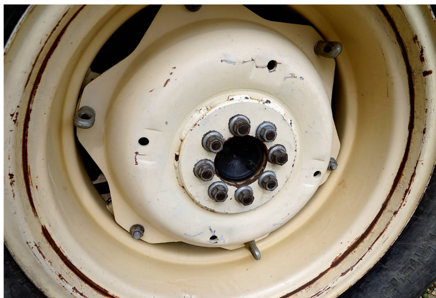
Jante renforcée du tracteur Lamborghini « 574-30 Cross ».
