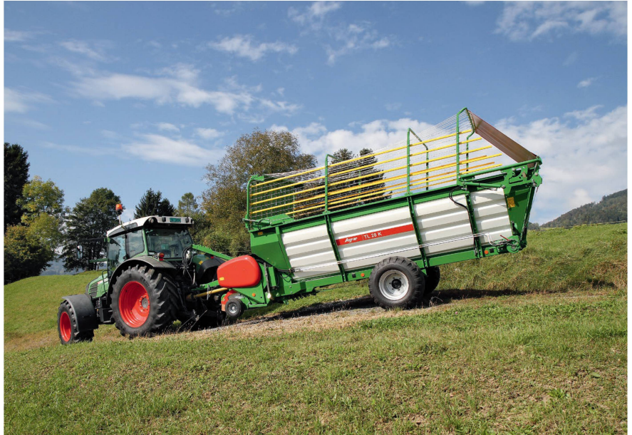
L'autochargeuse pour la montagne possède un centre de gravité bas, qui cependant s'élève au fur et à mesure que les charges s'alourdissent. Photo : Agrar
