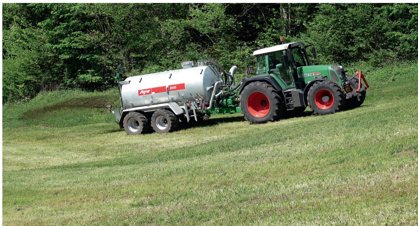
Grâce à l'essieu propulseur, la citerne peut aborder des pentes conséquentes sans dommages pour le terrain. Photos : Ruedi Burkhalter
