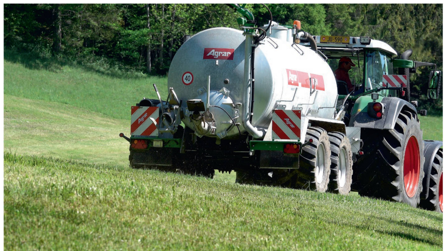
Avec son essieu tandem et ses pneus basse-taille, la citerne présente un centre de gravité bas et une assise large et stable.
