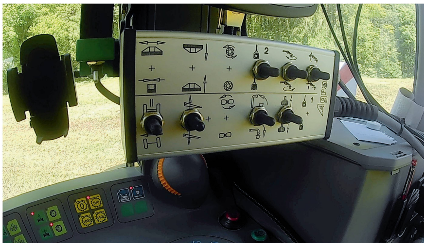
Les commandes électro-hydrauliques permettent de commander jusqu'à douze fonctions depuis la cabine du tracteur.
