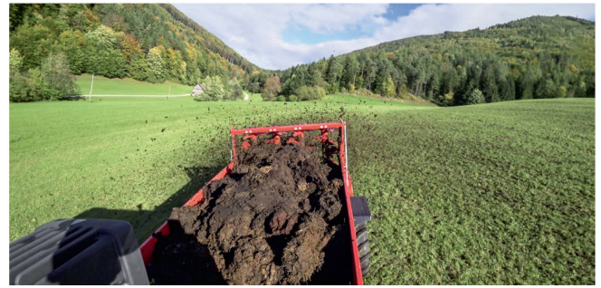
Les épandeurs arrière avec hérissons verticaux autorisent une largeur de travail de quelque huit mètres.
