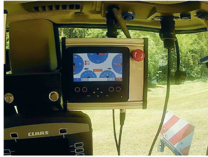
L'essieu moteur est géré depuis un terminal indépendant. L'écran couleur permet une bonne lecture des données.
