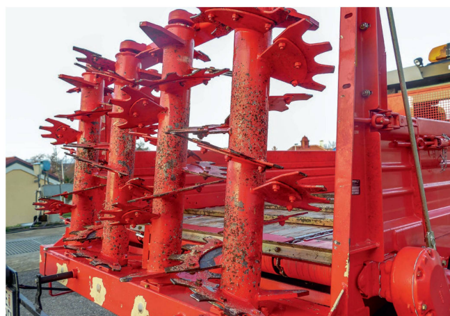
Le Reform «215» est également doté de quatre hérissons d'épandage verticaux avec lames de fraisage vissées et réversibles.
