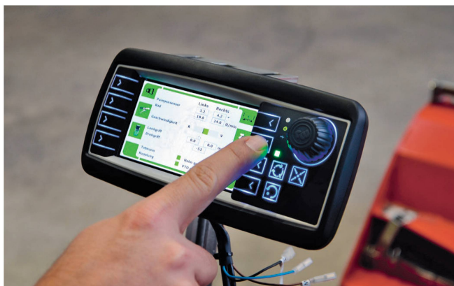
L'outil de diagnostic de Rapid permet de personnaliser les réglages électroniques et simplifie la recherche des pannes. Photo: Rapid
