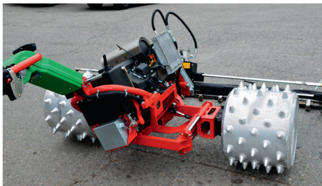
Le « Tecno », du Grison Aebli, est le seul modèle sur le marché à proposer un équilibrage bidimensionnel du centre de gravité. Photo: Ruedi
