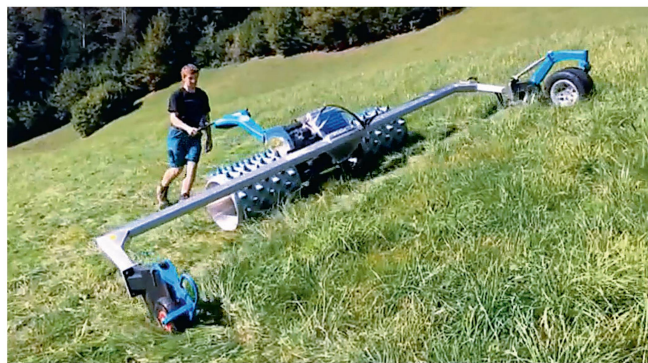
Sur ses barres extra-larges, Brielmaier monte des roues qui améliorent le flux de fourrage au niveau de l'extrémité du lamier et qui, avec leurs fixations excentriques, facilitent les manœuvres en marche arrière. Photo : Brielmaier
