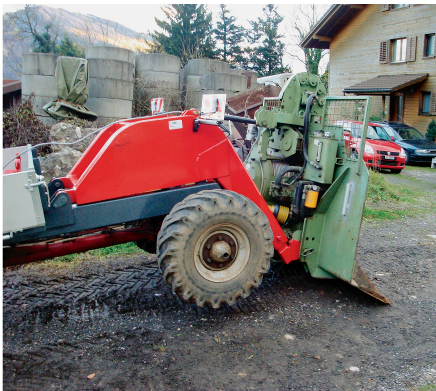
Grâce au relevage trois-points de Jordi, la plage d'utilisation du transporter peut être étendue à tous les outils portés traditionnels conçus pour ce mode de fixation. Photo: Jordi
