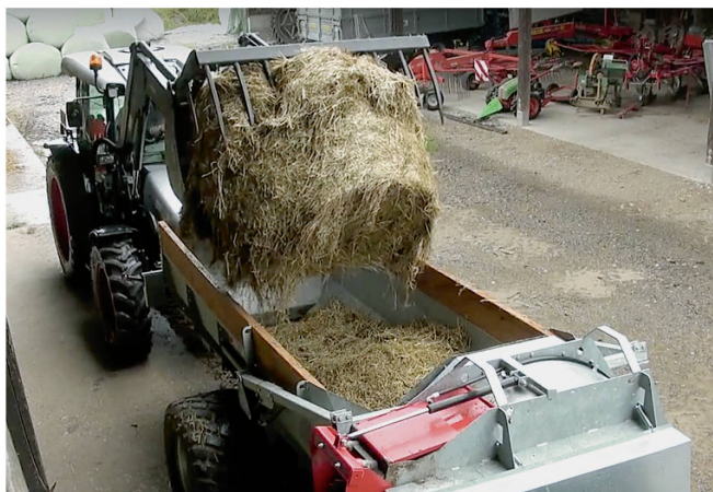
L'auxiliaire « Everyday » permet d'utiliser les épandeurs à épandage latéral de Gafner pour le travail d'affouragement et de préparation de la litière. Photo : Gafner
