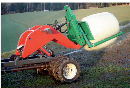
Le relevage trois-points de Jordi avec la fourche à balles.
