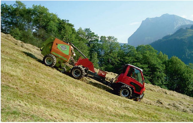
La presse à balles rondes montée sur le relevage trois-points ne modifie guère le centre de gravité du véhicule. Photo : Thomas Walder
