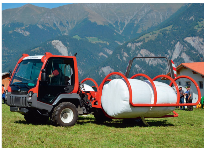
Ce système personnalisé développé par l'Allemand Gerg permet le transport de six balles rondes chargées avec le dispositif de chargement intégré. Photo : Ruedi Hunger
