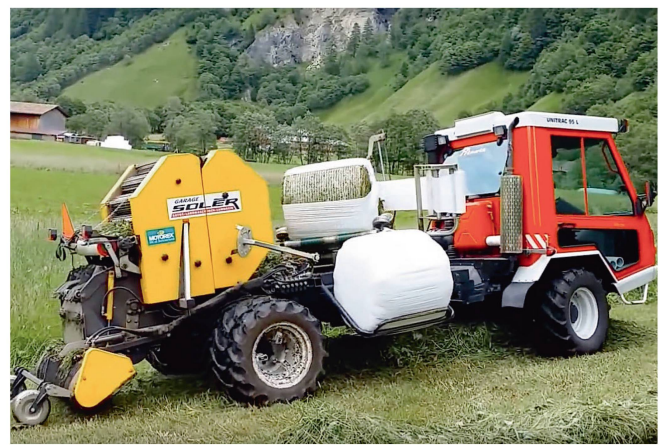
La presse-enrubanneuse «Prewitra» de Bürger permet de transporter trois balles rondes aux dimensions 80×90 cm. Photo : Bürger
