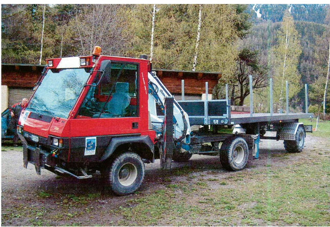
La surface de chargement et la charge utile augmentent beaucoup avec une semi-remorque. Il reste assez de place pour une grue. Photo : Jordi
