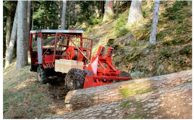
La superstructure forestière classique, certes plus chère que la version avec treuil trois-points, assure une meilleure répartition du poids. Photo : Jordi
