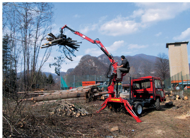
Certains transporteurs peuvent être munis d'un relevage trois-points, ce qui permet de leur ajouter des outils portés. Photo : Caron
