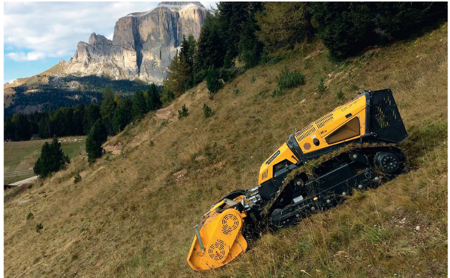
Les porte-outils radiocommandés sont particulièrement indiqués dans la lutte contre l'embroussaillage des alpages et des pâturages. Photo: McConnel
