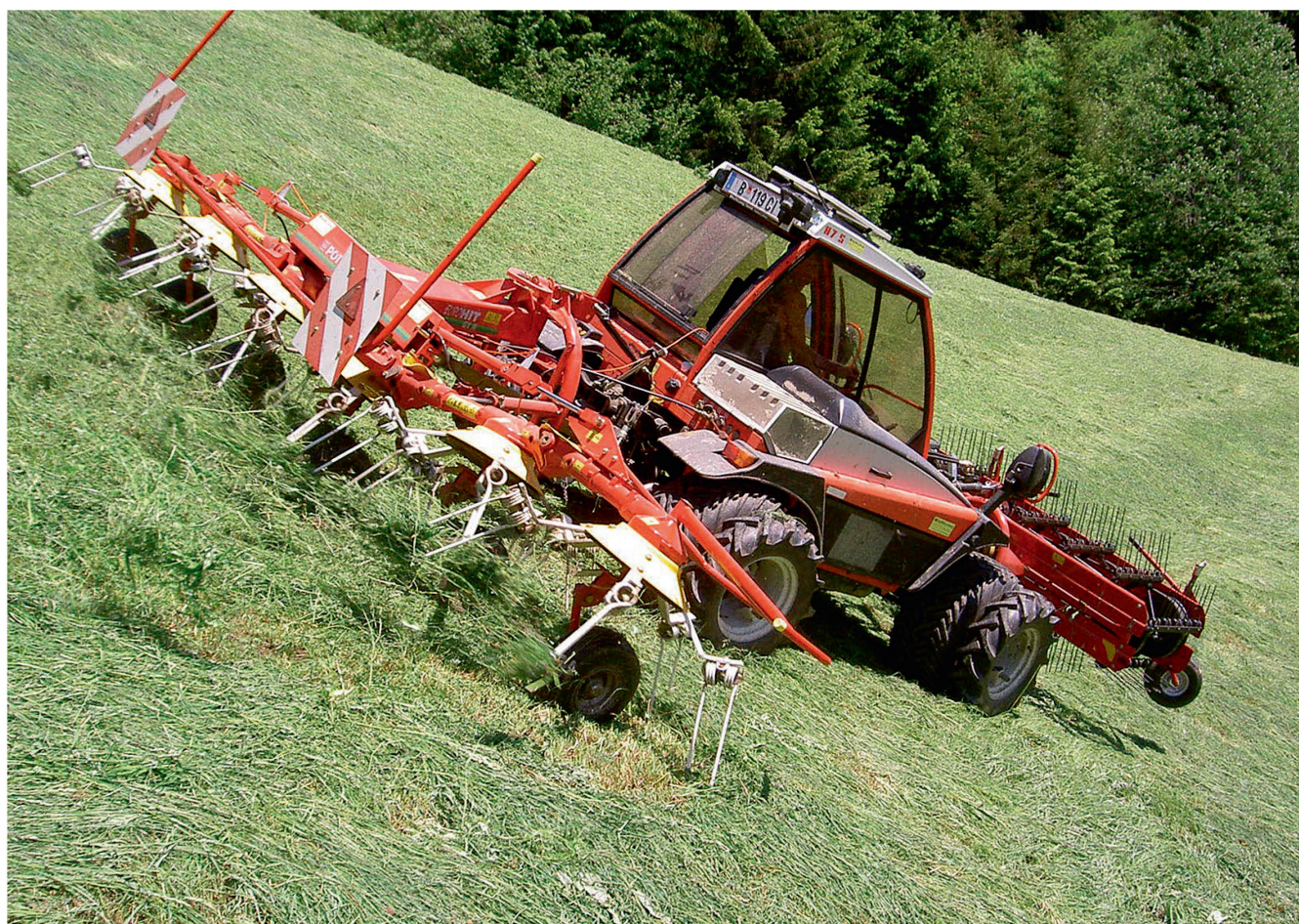
Dans les terrains en pente, la dynamique de masse de l'outil porté joue un rôle prépondérant. Photo : Reform
