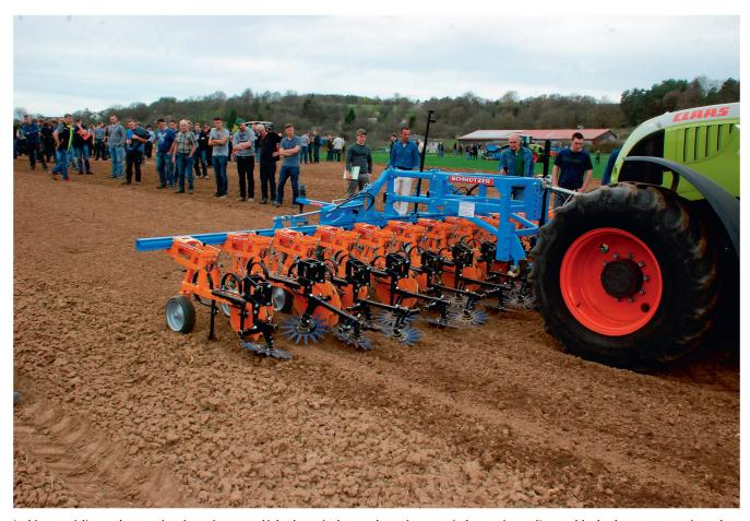
Le binage « à l'aveugle » consiste à pratiquer un désherbage à plat, quelques jours après les semis, sur l'ensemble du champ, y compris sur les rangs, à l'aide d'une bineuse/sarcleuse frontale de 6 mètres qui possède entre autres des rotors à doigts. Photos: Heinz Röthlisberger
