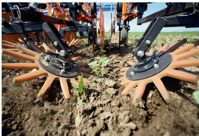
Sur la photo ci-dessus, les rotors à doigts traitent des plantes issues de levée. Ils sont dotés d'un angle d'attaque qui peut être réglé en fonction de la taille des végétaux. Photo : ldd
