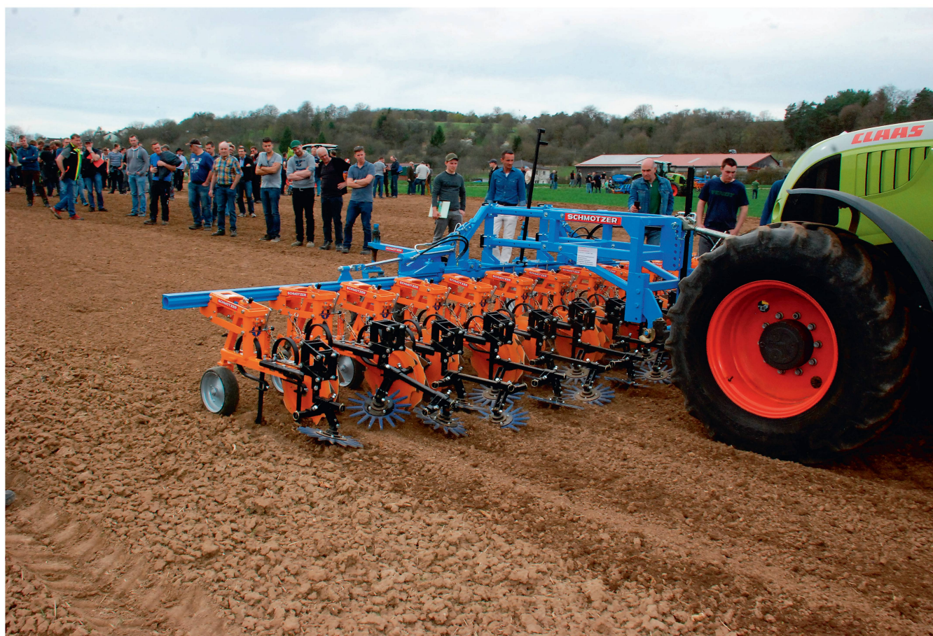
Le binage «à l'aveugle» consiste à pratiquer un désherbage à plat, quelques jours après les semis, sur l'ensemble du champ, y compris sur les rangs, à l'aide d'une bineuse/sarcleuse frontale de 6 mètres qui possède entre autres des rotors à doigts. Photos : Heinz Röthlisberger
