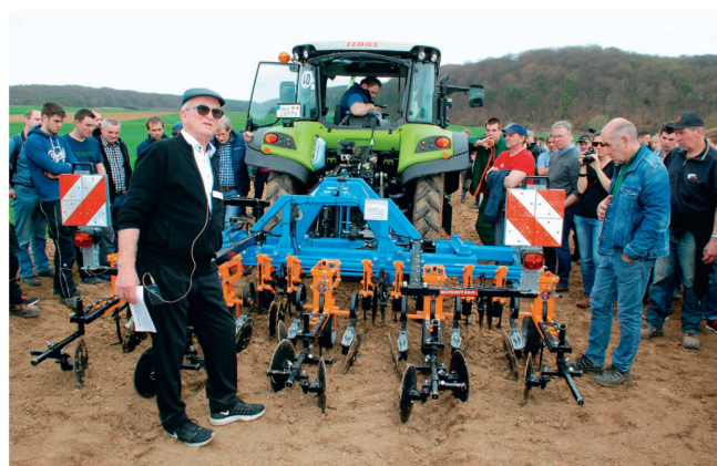
Ferdinand Wahl, directeur de la société Schmotzer, pose à côté de sa machine à entretenir les buttes. Celles-ci sont restaurées par les disques déflecteurs placés en aval après avoir été entamées par les coutres.
