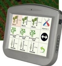
« Okio », le nouveau système de guidage par caméra avec son terminal. Grâce à un inclinomètre et un détecteur de relevage, il est possible de biner en situation de dévers sans risque de dérive latérale.
