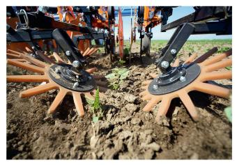
Sur la photo ci-dessus, les rotors à doigts traitent des plantes issues de levée. Ils sont dotés d'un angle d'attaque qui peut être réglé en fonction de la taille des végétaux. Photo: Idd
