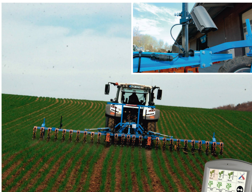
« Okio », le nouveau système de guidage par caméra avec son terminal. Grâce à un inclinomètre et un détecteur de relevage, il est possible de biner en situation de dévers sans risque de dérive latérale.
