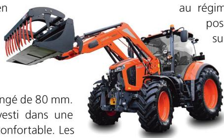
transmissions sont des 36AV/36AR. Le constructeur a aussi présenté le « M6121 » (photo), qui est doté d'une pompe hydraulique débitant 110 l/min. facilitant les travaux au chargeur frontal. Le « M6121 » est mû par un moteur de 6,1 l de 115 chevaux au régime nominal. Il dispose d'une réserve de surpuissance de 20 chevaux. La boîte à cinq vitesses dispose de six rapports enclenchables sous charge.
