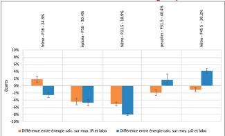
Erreurs de l'installation de laboratoire lors de la mesure de la teneur énergétique de plaquettes de différents types de bois, tailles (P16, P31.5, P45 S) et taux d'humidité (entre 18,9 et 40,4 %). Les divergences se basent sur une mesure comparative réalisée indépendamment de l'installation du test.
