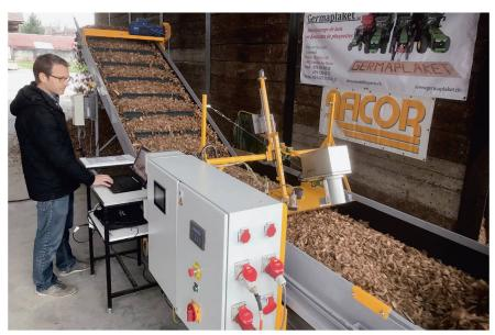
Thierry Stäger, chercheur à la HEIG-VD, se sert de la nouvelle installation de mesure. Le boitier aris argenté au-dessus du convoyeur est l'instrument infrarouge pour la mesure de l'humidité. La plaque jaune posée directement sur les plaquettes de bois sert à déterminer l'humidité avec des micro-ondes (cachée par l'instrument IR sur la photo).
