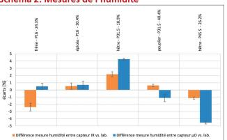
Erreurs de l'installation de laboratoire lors de la mesure infrarouge (orange) et à micro-ondes (bleu) de l'humidité pour différents types de bois, tailles de plaquettes (P16, P31.5, P45 S) et taux d'humidité (entre 18,9 et 40,4%). Les divergences se basent sur une mesure comparative réalisée indépendamment de l'installation du test: la mesure de l'humidité conformément à la norme se base sur celle de la masse à l'état brut et sur celle de la masse après le séchage absolu du bois à 105° C.
