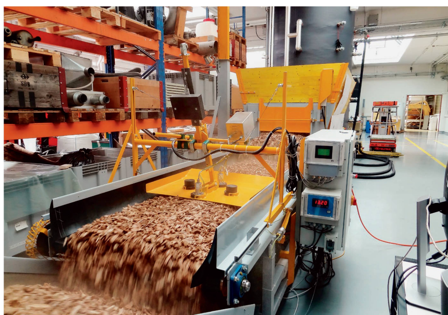
Les chercheurs de la Haute École d'Yverdon ont d'abord testé la mesure du poids et de l'humidité dans un laboratoire (photo). La plaque jaune mesure l'humidité par micro-ondes et l'instrument gris argenté (au fond) par infrarouge. Photo: HEIG-VD
