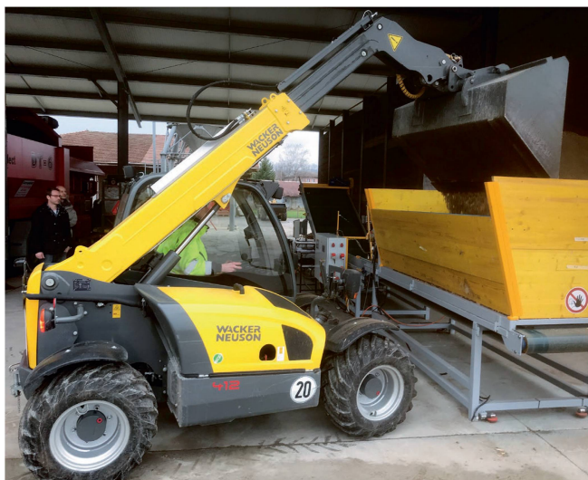
Cet appareil de mesure est utilisé pour l'essai chez le fournisseur Germaplaket à Yverdon : un chargeur télescopique déverse dans la trémie les plaquettes qui arrivent sur la bande de convoyage.
