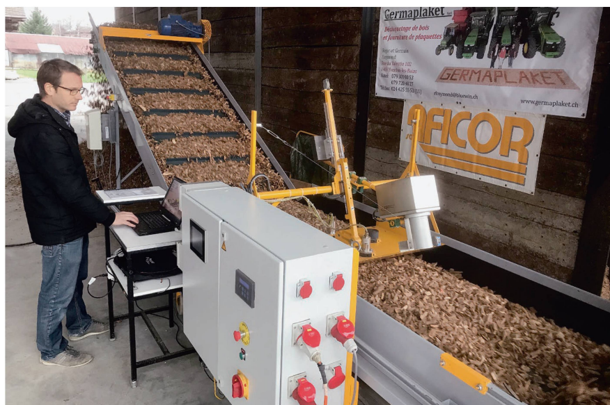
Thierry Stäger, chercheur à la HEIG-VD, se sert de la nouvelle installation de mesure. Le boîtier gris argenté au-dessus du convoyeur est l'instrument infrarouge pour la mesure de l'humidité. La plaque jaune posée directement sur les plaquettes de bois sert à déterminer l'humidité avec des micro-ondes (cachée par l'instrument IR sur la photo).
