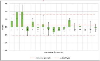
Le schéma montre la précision avec laquelle l'installation du laboratoire de la Haute École d'Yverdon a déterminé le poids des plaquettes en 17 mesures. Les premières mesures étaient assez imprécises, mais l'amélioration de l'étalonnage a permis de réduire les erreurs de mesure pour obtenir un décalage bien inférieur à 1 %. Les divergences mesurées se basent sur une mesure comparative réalisée indépendamment de l'installation de test. Schéma: HEIG-VD
