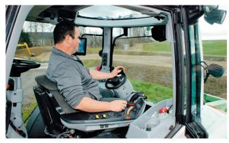
Le poste de travail dans la cabine du «N174 Direct» avec le dispositif à poste inversé «TwinTrac». Les Duperrex ont utilisé le tracteur en conduite inversée pendant la moitié de la première saison.
