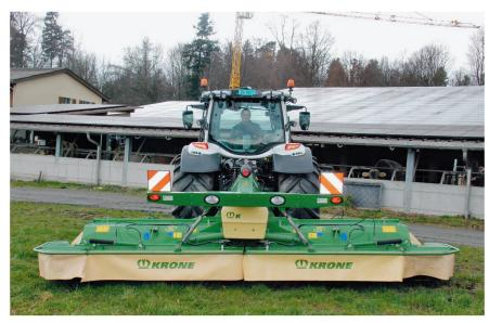
Le dispositif à poste inversé de leur tracteur permet aux Duperrex d'utiliser un combiné de fauche spécial de 5,40 m porté à l'arrière, conçu initialement pour l'automotrice «Big M» de Krone
