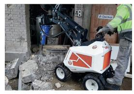
L'hydraulique dispose d'un refroidissement assez performant pour une utilisation en continu d'outils exigeants.
