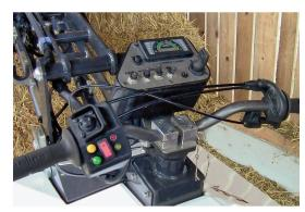
Tous les éléments de pilotage sont réunis sur le guidon, ainsi que les cadrans et le compteur d'heures rétroéclairés.
