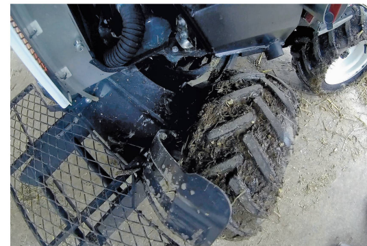
L'effet de braquage est obtenu aussi bien par l'articulation centrale que par les rotules des roues.
