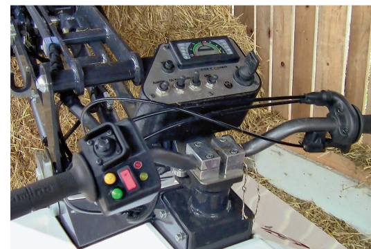
Tous les éléments de pilotage sont réunis sur le guidon, ainsi que les cadrans et le compteur d'heures rétroéclairés.
