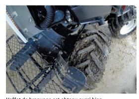
L'effet de braquage est obtenu aussi bien par l'articulation centrale que par les rotules des roues.
