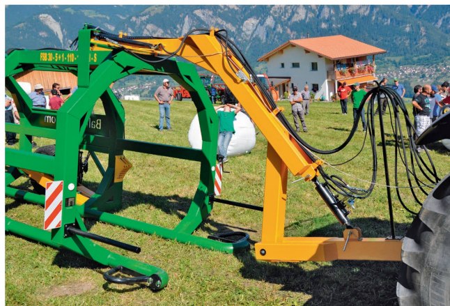
Avec son timon déportable, le « Ballenboy » ramasse les balles en marche avant. Photos : R. Hunger
