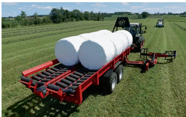
L'Anderson «RBM 2000» peut emporter 14 ou 20 balles d'ensilage qu'elle décharge debout ou couchées. Photos: Anderson Group
