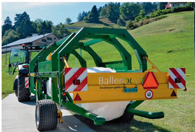
Avec son timon déportable, le « Ballenboy » ramasse les balles en marche avant. Photos : R. Hunger
