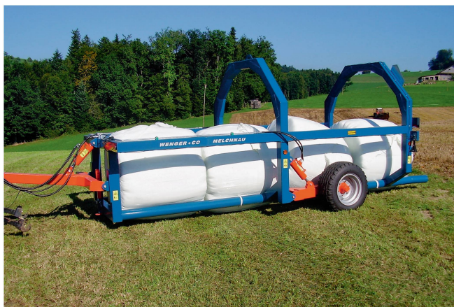
La remorque proposée par Wenger possède peu de pièces mobiles et charge les balles en marche arrière. Photos : Trumag
