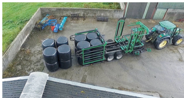
Cette machine développée par un éleveur laitier irlandais travaille avec une cage munie de rouleaux. Photos: agriland.ie
