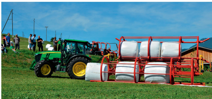
Le Keltec «Bale Transporter» travaille avec deux pinces qui peuvent s'imbriquer pour le transport. Photos : R. Hunger
