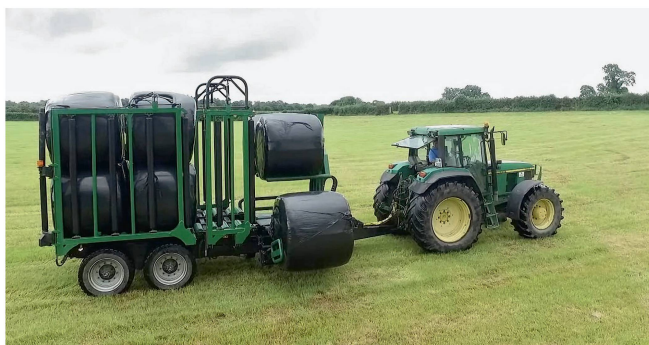
Cette machine développée par un éleveur laitier irlandais travaille avec une cage munie de rouleaux. Photos: agriland.ie
