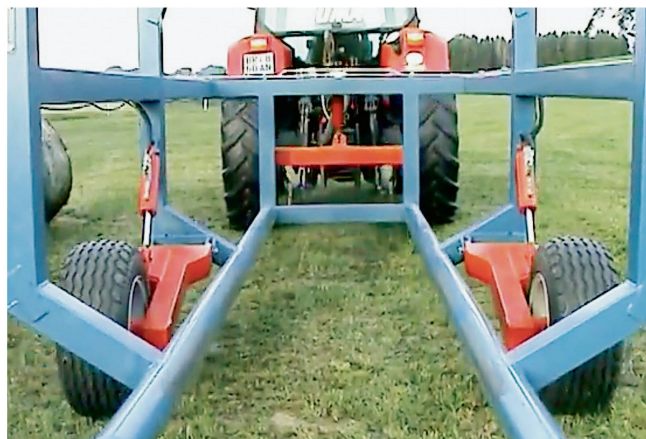
La remorque proposée par Wenger possède peu de pièces mobiles et charge les balles en marche arrière. Photos : Trumag
