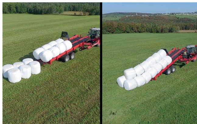
L'Anderson «RBM 2000» peut emporter 14 ou 20 balles d'ensilage qu'elle décharge debout ou couchées. Photos: Anderson Group
