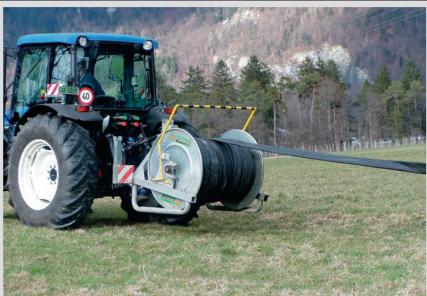
Dans les exploitations unipersonnelles, l'enrouleur de tuyaux qui fonctionne avec le système hydraulique du tracteur doit être commandé uniquement depuis la cabine. Il est dangereux de se tenir près de l'enrouleur et de guider les tuyaux, car le mécanisme d'enroulement peut happer une personne.
