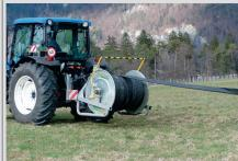
Dans les exploitations unipersonnelles, l'enrouleur de tuyaux qui fonctionne avec le système hydraulique du tracteur doit être commandé uniquement depuis la cabine. Il est dangereux de se tenir près de l'enrouleur et de guider les tuyaux, car le mécanisme d'enroulement peut happer une personne.
