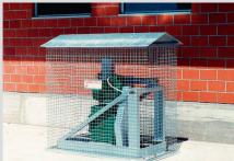
Le grillage entourant complètement un brasseur de lisier fixe empêche tout accès aux parties mobiles de la machine. Après utilisation ou réparation du brasseur, la protection doit impérativement être remise en place. Lors du brassage, les gaz peuvent s'échapper par la petite ouverture nécessaire au fonctionnement
