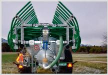
Les panneaux de signalisation, les catadioptres et les feux peuvent être salis même avec les machines modernes pour l'épandage du lisier. Si nécesssaire, le chauffeur a l'obligation de tous les nettoyer.
