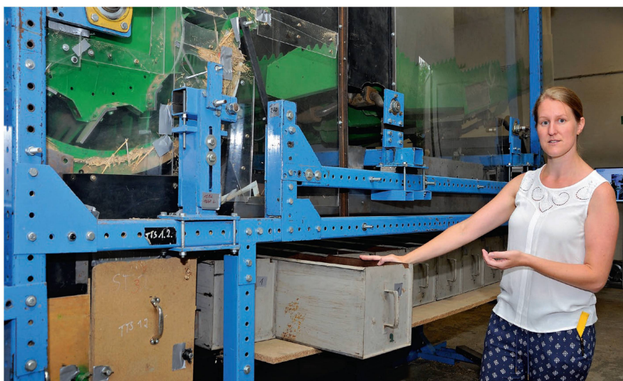
Les tiroirs placés sous le banc d'essai des moissonneuses-batteuses aident Anja Eggerl à localiser les pertes de grains dans la chaîne de battage.
