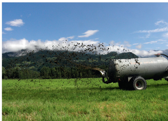
L'épandeur pendulaire de Möscha est livré en largeurs de travail allant jusqu'à 15 m. La forme de la tête basculante et la déviation du jet assurent la formation de grosses gouttes.
