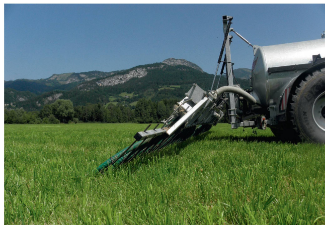
D'une largeur de travail de 9 m, l'épandeur à injecteur à patin Fliegl injecte le lisier dans le sol via des buses distantes de 25 cm seulement.
