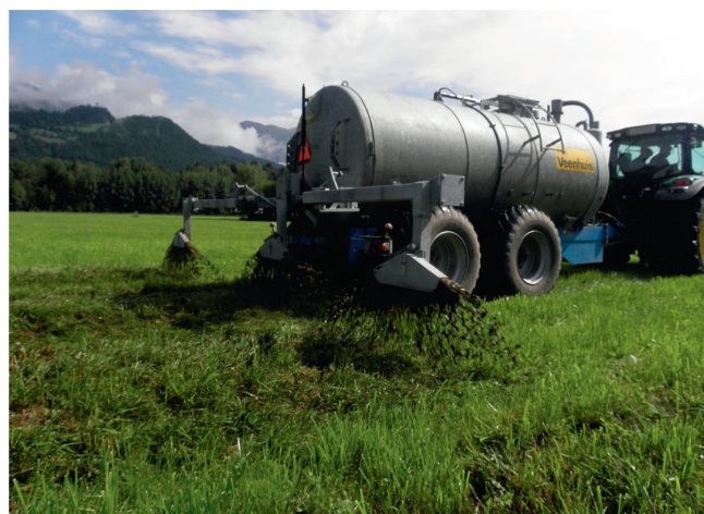
L'«épandeur suisse» à basse pression de Bücheler et Schönenberger a une largeur de travail de 7,5 m, trois distributeurs séparés de 2,5 m et pèse 250 kg.
