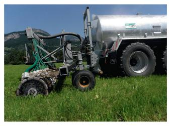
La machine à disques fendus Fliegl a une largeur de travail de 6,3 m et pèse 1400 kg.
