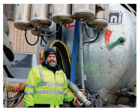
René Messer sous les réservoirs du système qu'il a conçu pour purger les tuyaux d'épandage en utilisant l'air comprimé produit par son tracteur. Photo: Dominik Senn
