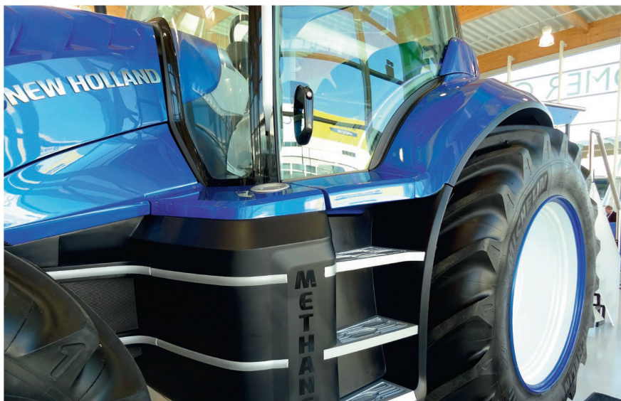
Les réservoirs en structure de tuyaux à plusieurs couches fabriqués en matériaux composites sont placés à l'avant et latéralement sous la cabine.
