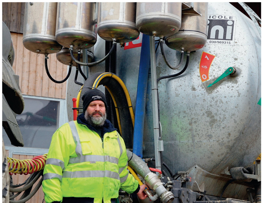
René Messer sous les réservoirs du système qu'il a conçu pour purger les tuyaux d'épandage en utilisant l'air comprimé produit par son tracteur. Photo : Dominik Senn
