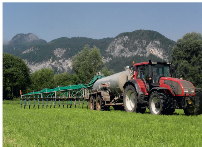
Ce modèle d'épandeur à rampe pendillard de 2011 de Kotte n'est plus disponible. D'un poids de 800 kg, il a une largeur de travail de 12 m.
