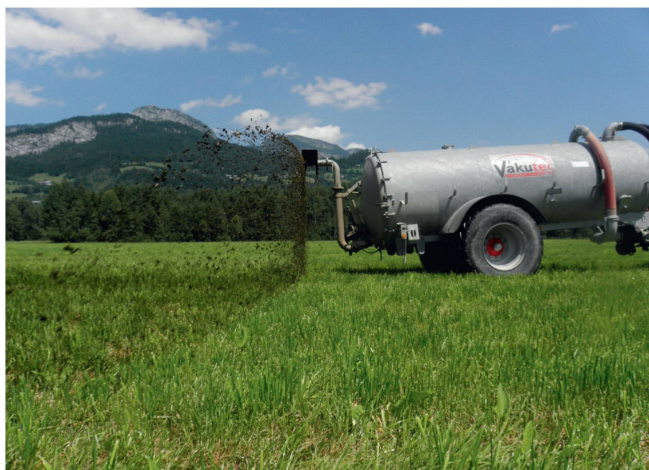
L'épandeur à tête distributrice Vakutec dispose d'une largeur de travail de 12 m. Les débits se règlent en changeant les buses.
