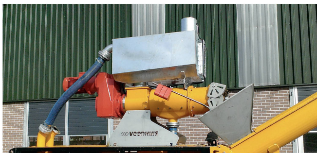
Les séparateurs avec réservoir d'alimentation supérieur ne nécessitent pas de tuyau de trop-plein.
