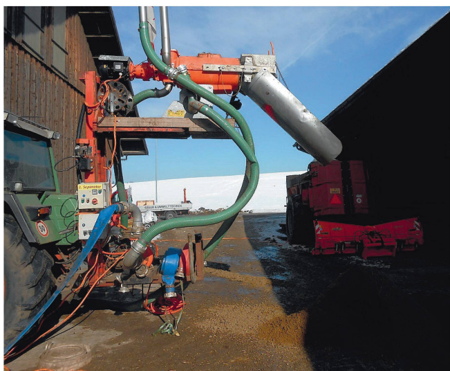
Ce séparateur de lisier mobile a été installé sur une colonne d'élévateur pour faciliter son déplacement et le doter d'un trop-plein surélevé.
