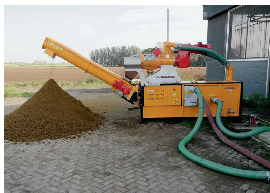
Les solutions « Plug&Play » (ici une Veenhuis) rassemblent tous les organes et éléments sur un châssis facile à déménager d'une exploitation à une autre.
