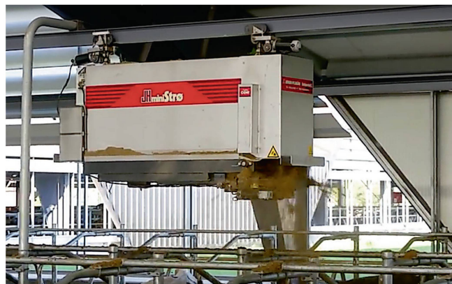
JH-Agro propose ce « MiniStro », un système idéal pour le paillage automatique avec de l'extrait solide de lisier.
