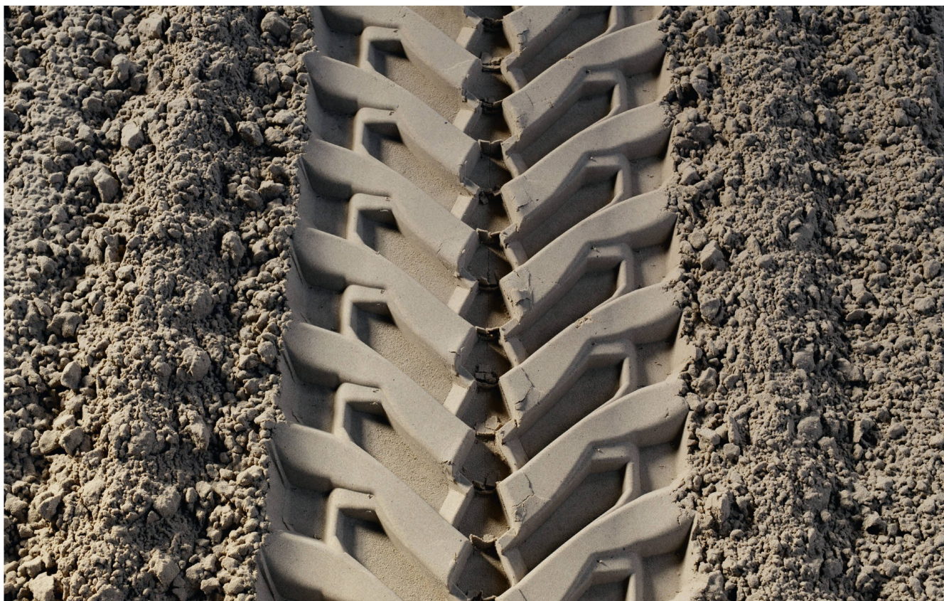
La pression détermine la largeur de l'empreinte des pneus « EvoBib » de Michelin. Photos : ldd
