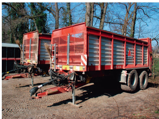
L'exploitation du « Château du Crest » transborde chaque année entre 25 000 et 30 000 tonnes de fumier et de compost avec ces deux épandeurs de 27 m 3 .
