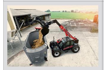
Il faut privilégier un remplissage indirect des mélangeuses à l'aide d'un chargeur, d'un pont roulant ou d'un tapis roulant.
