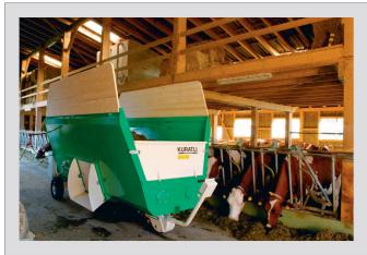
S'il n'est pas possible de procéder différemment, le remplissage de la mélangeuse par le haut ne doit être fait que depuis une plate-forme ou par un trou sécurisé. En outre, la machine doit impérativement être immobilisée
