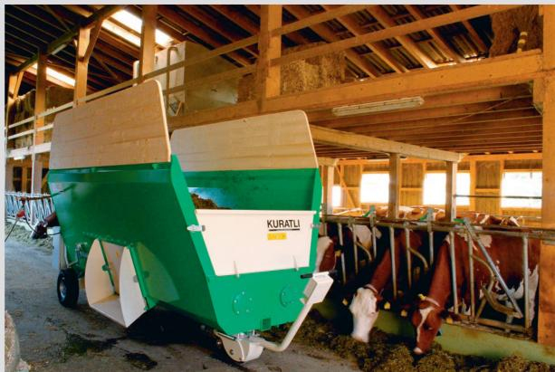
S'il n'est pas possible de procéder différemment, le remplissage de la mélangeuse par le haut ne doit être fait que depuis une plate-forme ou par un trou sécurisé. En outre, la machine doit impérativement être immobilisée.
