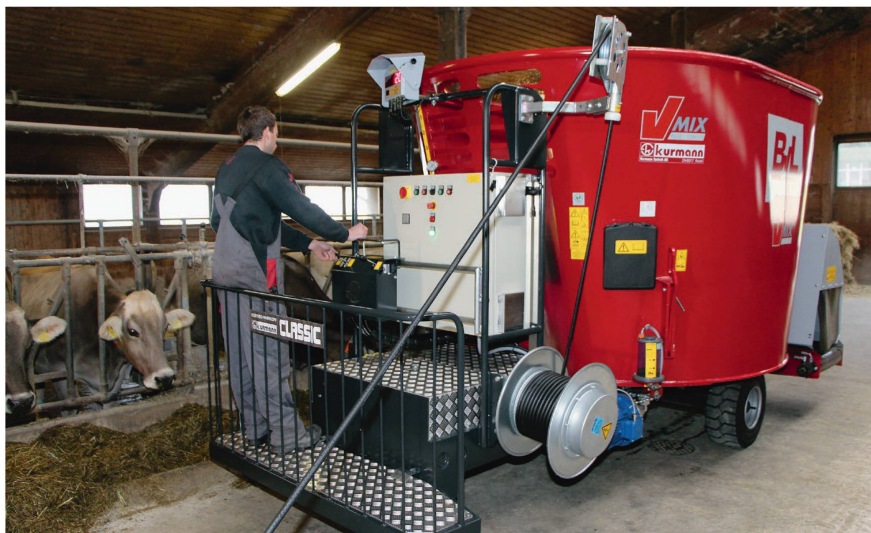
Comparée à l'AFS, la mélangeuse parvient à mieux couper l'herbe ensilée et le foin. Les mélangeuses électriques constituent une alternative. Photo: Kurmann
