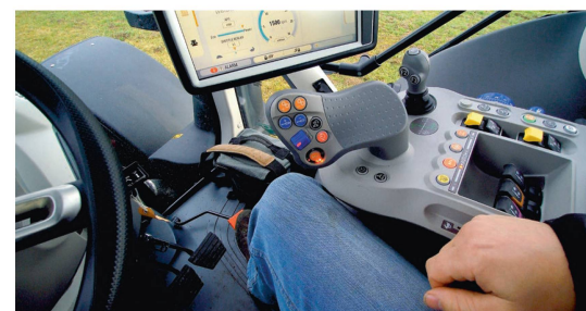
Les groupes et les rapports se changent via le levier multifonction de l'accoudoir.
