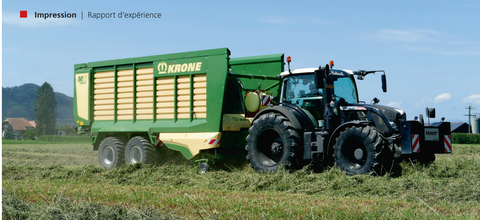
La nouvelle autochargeuse «MX 370 GD» avec paroi avant pivotante d'Oskar Schenk. On aperçoit le système de dosage des conservateurs d'ensilage installé par ce dernier. Photos : ldd
