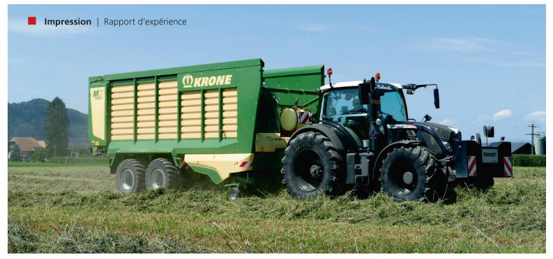
La nouvelle autochargeuse « MX 370 GD » avec paroi avant pivotante d'Oskar Schenk. On aperçoit le système de dosage des conservateurs d'ensilage installé par ce dernier. Photos: Idd
