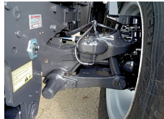
La suspension à roues indépendantes de l'essieu avant « Dynamic » est commandée électroniquement.
