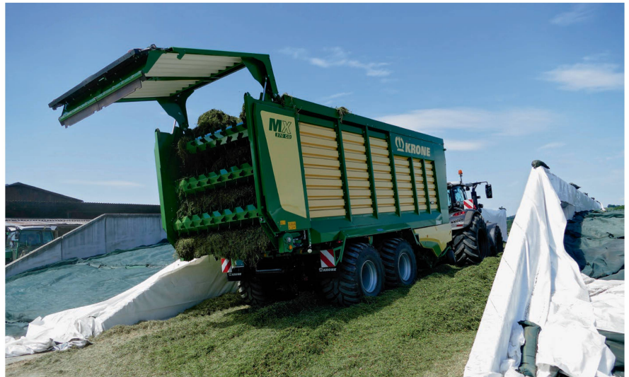
Les tambours de dosage de 470 mm de diamètre permettent un déchargement rapide de la remorque.
