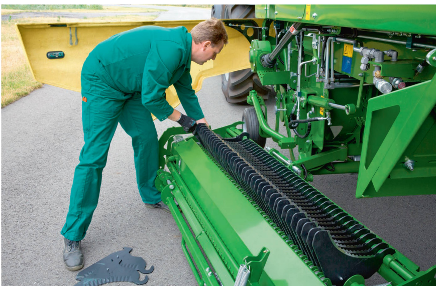
La barre de coupe, prévue pour recevoir jusqu'à 41 couteaux, peut pivoter latéralement vers l'extérieur pour changer les couteaux.
