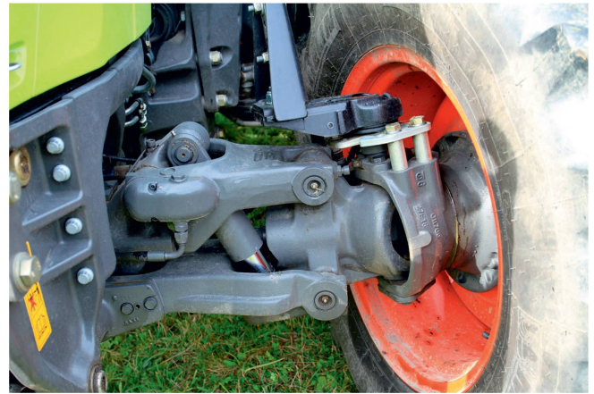
Le pont avant de Carraro avec suspension de roue individuelle autorise un débattement de 90 mm.
