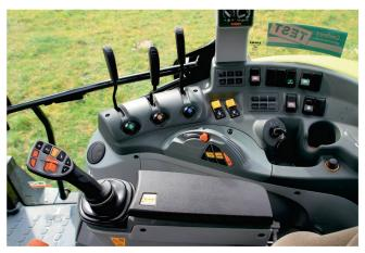
Les éléments de commande sur la console latérale droite et le joystick multifonctions sur l'accoudoir sont facilement accessibles.
