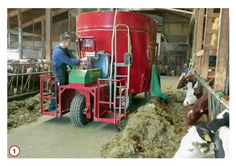
Cela fait des années déjà qu'Agro Technik Zulliger SA, de Hüswil (LU), équipe des mélangeuses verticales à une vis Strautmann d'une tête électrique construite par ses soins. Elle a d'abord utilisé des transmissions mécaniques et des variateurs de fréquence, avant de passer au tout hydraulique à partir de 2014 et de rebaptiser ses machines « Verti-Mix ESF-H ».
