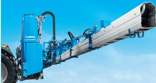
Les pulvérisateurs Sirius offrent une solution adaptée à chaque exploitation, depuis le modèle de base Sirius 8 robuste et efficace, jusqu'au Sirius 10 à régulation électronique, rampe en profilé aluminium en largeur 15 à 30 m, un équipement complet et de nombreuses options utiles ; il vous offre beaucoup d'avantages :
