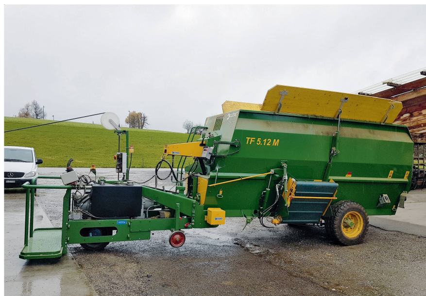
En cas de besoin, cette tête d'entraînement électrique Odermatt se démonte assez aisément et libère le timon original de la remorque. Photo : R. Burkhalter/LDD
