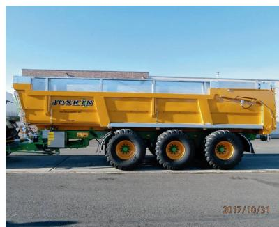
hausses fixes (en option) de 25 cm sur les autres côtés, la caisse atteint une hauteur de 1,75 m et une contenance de 36,2 m<sup>3</sup>. Sur la version standard, la course de la rehausse hydraulique est limitée à 25 cm pour une hauteur totale de caisse de 1,50 m.
