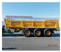
hausses fixes (en option) de 25 cm sur les autres côtés, la caisse atteint une hauteur de 1,75 m et une contenance de 36,2 m³. Sur la version standard, la course de la rehausse hydraulique est limitée à 25 cm pour une hauteur totale de caisse de 1,50 m.
