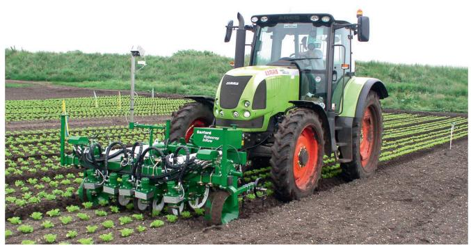
Basé sur un système d'imagerie, le système de régulation des adventices «Robocrop» de Garford est exemplaire par sa haute valeur écoloqique. Photo: Garford
