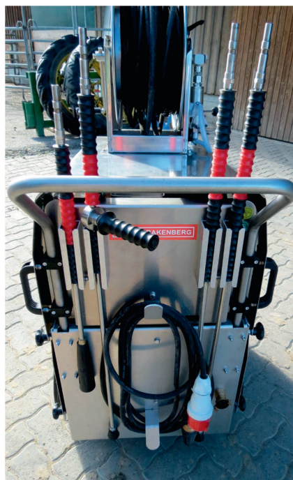
Le capot résistant en métal protège l'appareil de l'eau et de la saleté.
