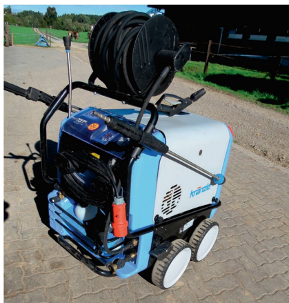
Équipement complet avec deux lances à double tuyau, une lance normale et une rotabuse.
