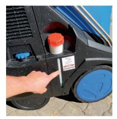
Un indicateur simple, mais fiable, pour le réservoir à diesel.
