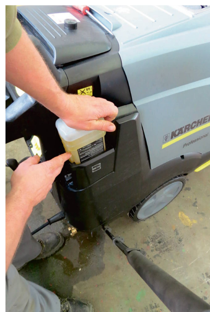
Une cartouche de détartrage est placée sur le côté.
