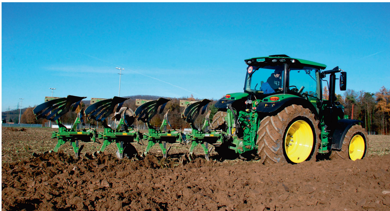
La charrue Amazone «Cayros XM 4-950 VS» à 4 socs est conçue pour des tracteurs jusqu'à 140 chevaux. Photos : H. Röthlisberger
