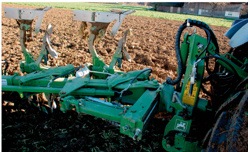
Les commandes du réglage hydraulique de la largeur de coupe et de labour. Au centre gauche de l'image, on voit l'indicateur de largeur, que le conducteur voit depuis son poste.
