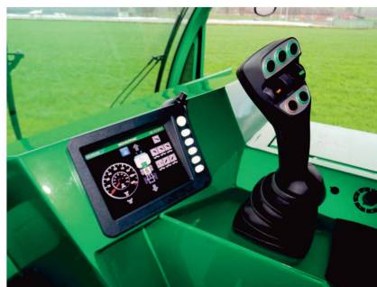
Le joystick gère toutes les fonctions de conduite, de transmission et hydrauliques du transporteur.
