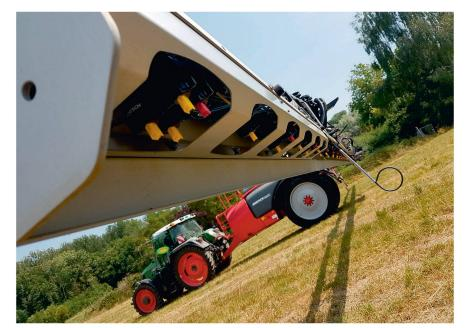
Des portes-buses différents sont montés en alternance à 50 et à 25 cm.
