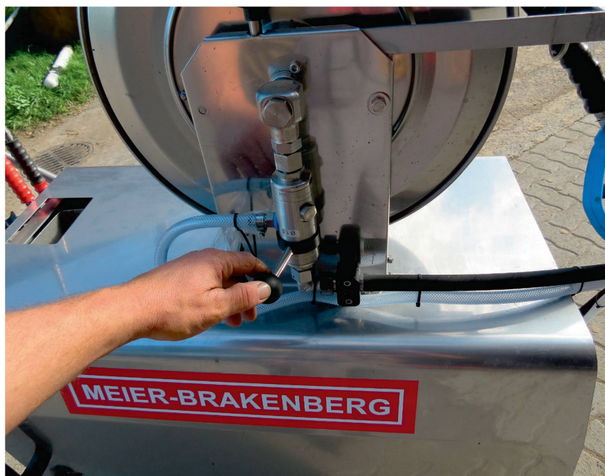
Robinet de commutation pour l'aspiration de détergent.
