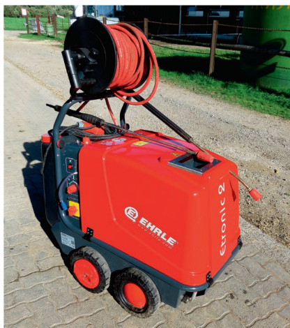
Sur le côté droit, on distingue un tuyau aspirant le détergent de l'extérieur.
