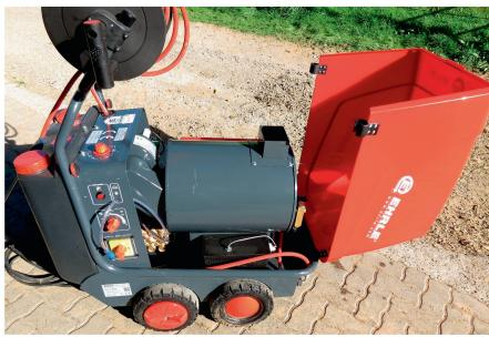
Simple et fonctionnel: un capot en plastique en une pièce.
