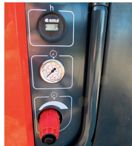
Côté gauche avec compteur horaire, témoin de pression et régulateur de pression.
