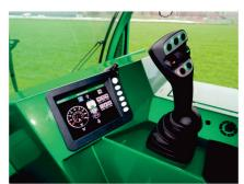
Le joystick gère toutes les fonctions de conduite, de transmission et hydrauliques du transporteur.
