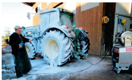
Avec une lance à mousseur, on peut appliquer des détergents de toutes natures de manière économique et efficace.
