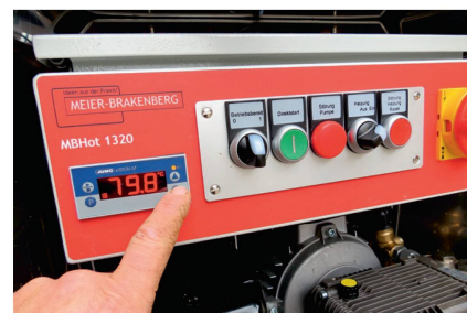
La température peut être réglée via un clavier à membrane.
