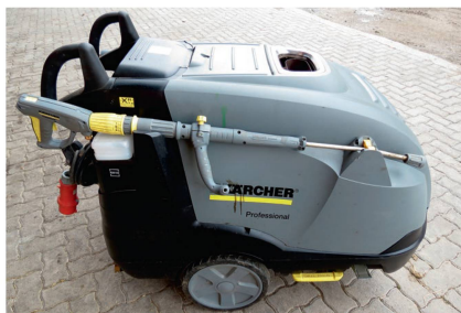
L'appareil est très maniable grâce aux deux poignées de réglage et aux roues mobiles à l'avant.
