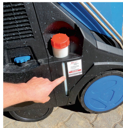
Un indicateur simple, mais fiable, pour le réservoir à diesel.
