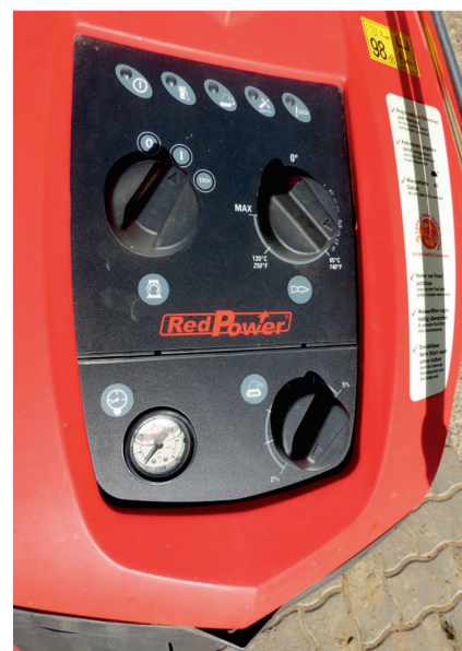
Le tableau de bord est équipé de trois commutateurs et de voyants lumineux.
