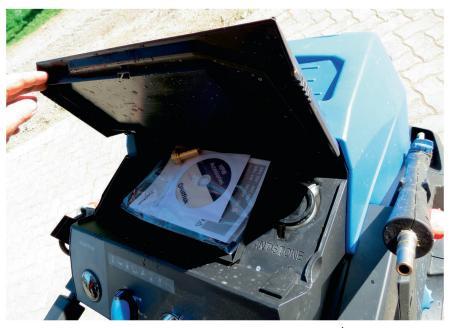
Le compartiment de rangement ménage de la place sur les accessoires. À droite, à l'extérieur, l'embout de remplissage pour l'adoucissant.
