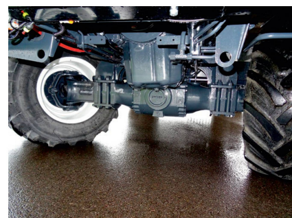
Les essieux de Dana supportent une charge maximale de 7 t chacun. L'angle de braquage est de 50°.
