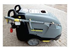
L'appareil est très maniable grâce aux deux poignées de réglage et aux roues mobiles à l'avant.
