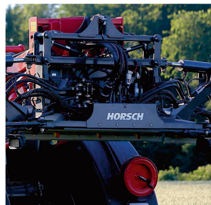
La rampe est suspendue à deux parallélogrammes qui servent aussi à son guidage.
