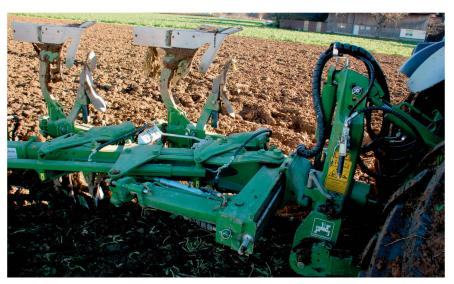
Les commandes du réglage hydraulique de la largeur de coupe et de labour. Au centre gauche de l'image, on voit l'indicateur de largeur, que le conducteur voit depuis son poste.
