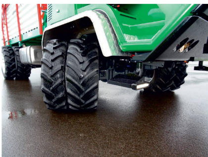
Solution élégante : le feu de circulation diurne est intégré dans la partie inférieure du marchepied.
