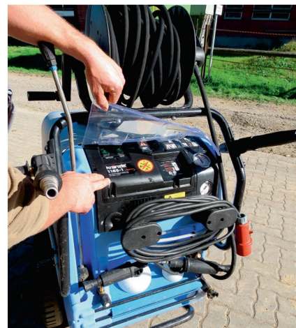
Un revêtement transparent protège le tableau de bord et le commutateur.
