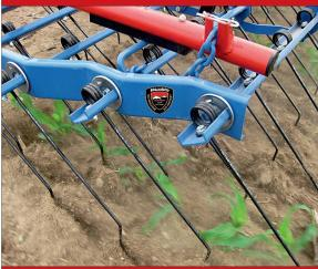
Les dents d'étrilles sont de différentes formes, longueurs et diamètres et se composent de différents types d'acier. En conséquence, la force exercée par les dents dans le sens de déplacement (longitudinale) ou perpendiculaire à celui-ci (transversale) est spécifique. Les dents plus longues aplanissent mieux les irrégularités du terrain.
